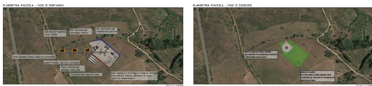
Figura 5.27 - Schematizzazione fase di montaggio e fase di esercizio piazzola EST04
