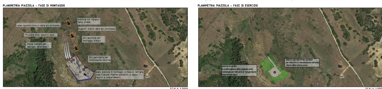
Figura 5.17 - Schematizzazione fase di montaggio e fase di esercizio piazzola ESC04
