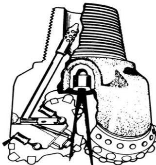
**Figura 4-1: scalpello di perforazione**
