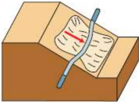
Fig. 12 - A sinistra il modello illustra l'interazione tra una frana ed una condotta disposta perpendicolarmente alla direzione di movimento della frana (Treccani). A destra: un oleodotto che si è spostato lateralmente di 9,5 m a causa di una frana.
