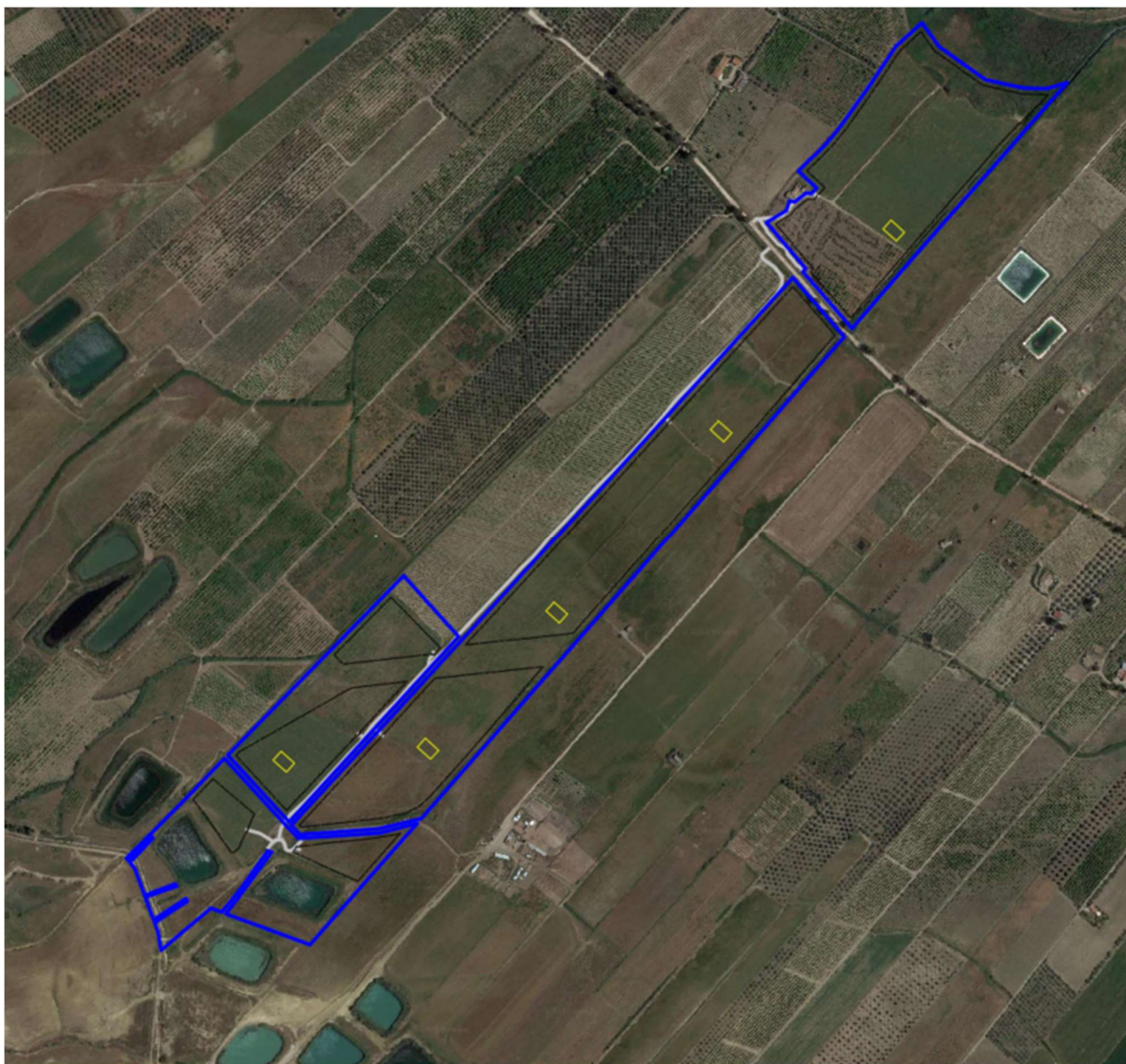
Figura 3-1 – Inquadramento aree di deposito macchinari e materiale e di stoccaggio delle terre e rocce da scavo (in giallo) e recinzione dell'impianto (in nero)
