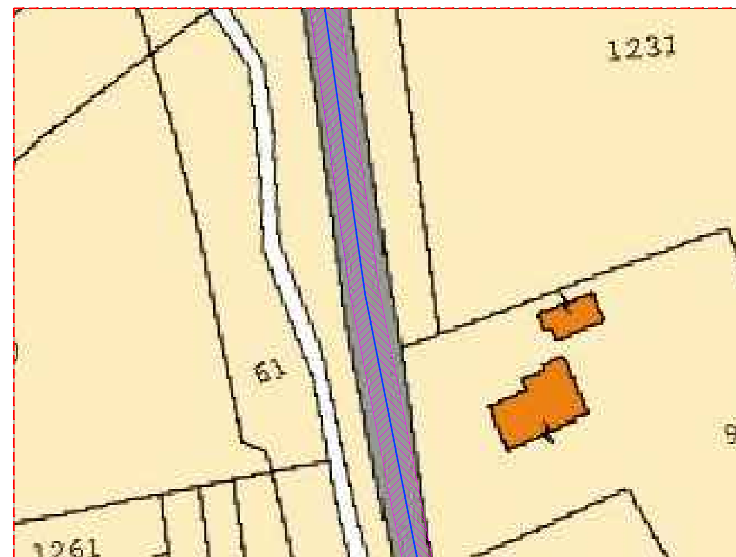
PARTICOLARE TRACCIATO ELETTRODOTTI CON RAPPRESENTAZIONE DELLA FASCIA DI ASSERVIMENTO PER POSA, ESERCIZIO E MANUTENZIONE ELETTRODOTTI SCALA 1:500
