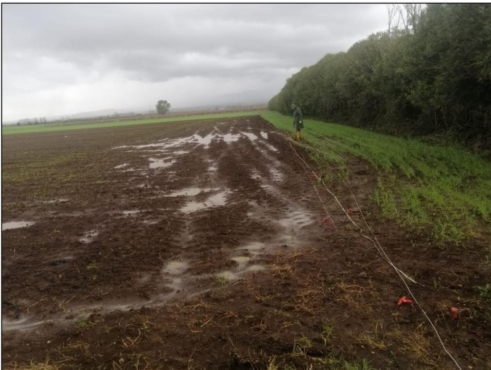
*Esecuzione profilo sismico a rifrazione 1-1'*
