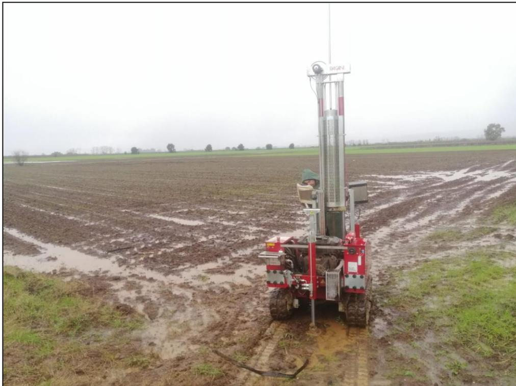
*Esecuzione prova penetrometrica dinamica continua – DPSH 1*
