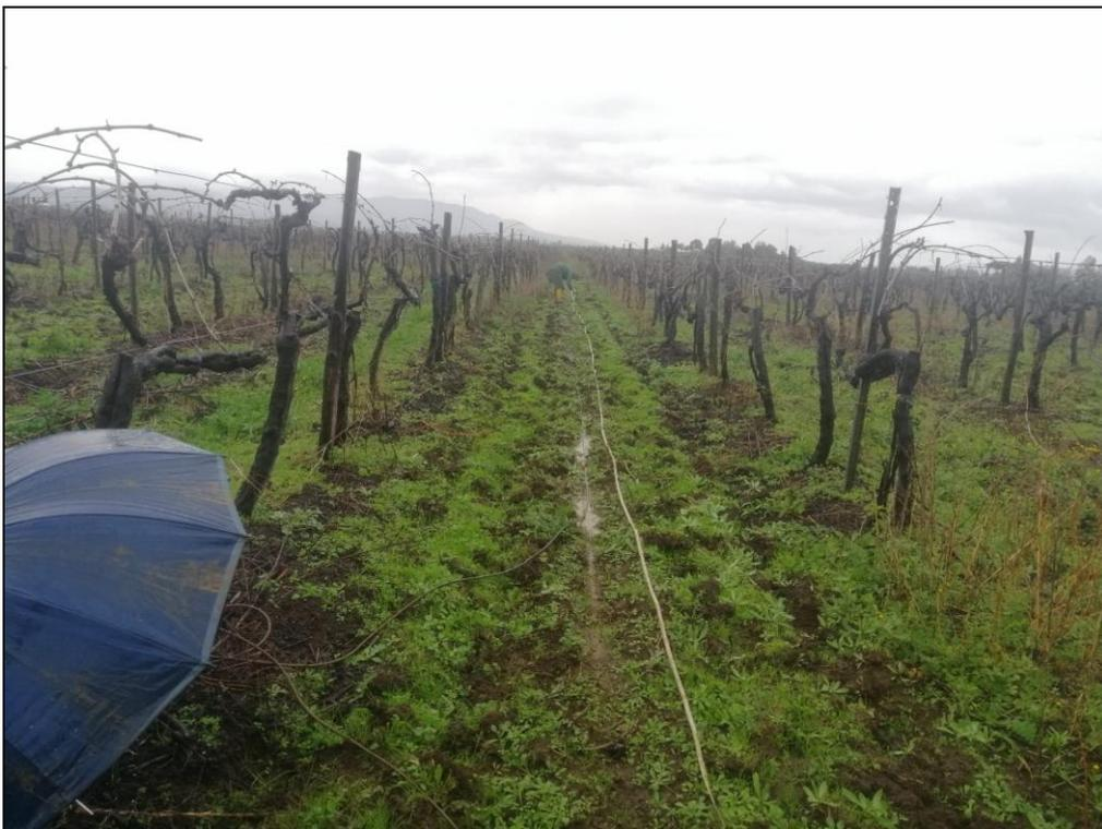
*Esecuzione profilo sismico a rifrazione 5-5'*
