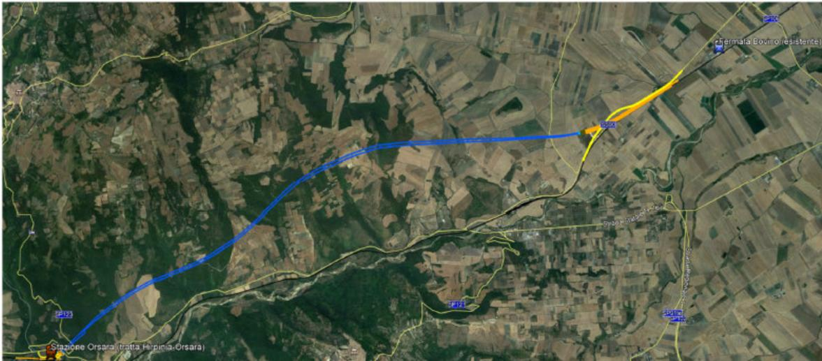
Figura 3-2. Corografia della linea. In blu la tratta in galleria, in arancio la tratta in rilevato ed in giallo le nuove viabilità.
