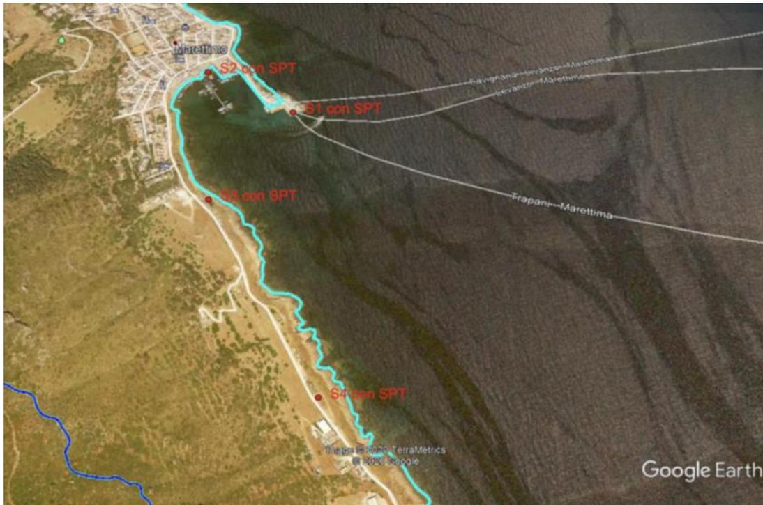
Figura 67 - Ubicazione sondaggi geognostici in foro con SPT
