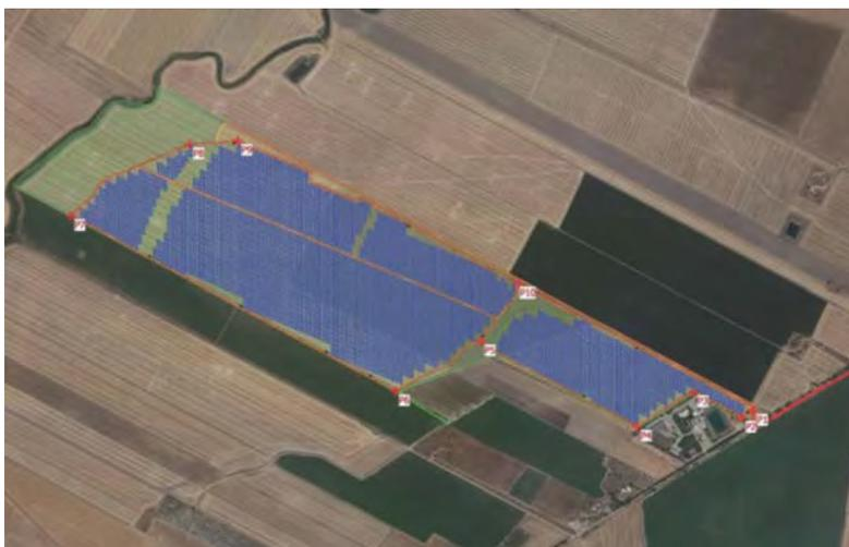
Il progetto proposto è un agrovoltaico, ossia i pannelli saranno sufficientemente sollevati dal suolo in modo da consentire la coltivazione del terreno sottostante, affiancando così la produzione agricola a quella elettrica.
