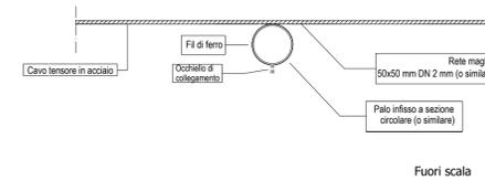
Dettaglio collegamento pali obliqui - Dettaglio A
