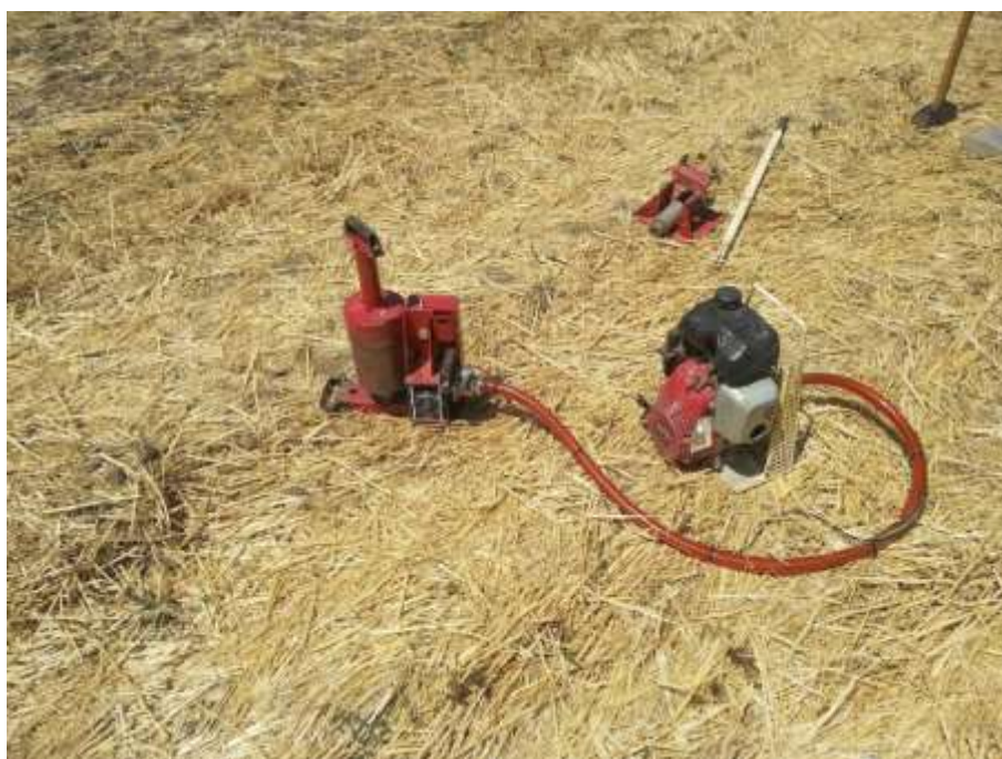
Particolare prova penetrometrica dinamica
