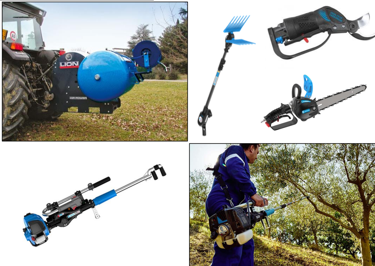
Figura 7.2: Compressore PTO per il funzionamento di strumenti pneumatici per l'arboricoltura e scuotitore motorizzato per la raccolta (Foto: Campagnola)
