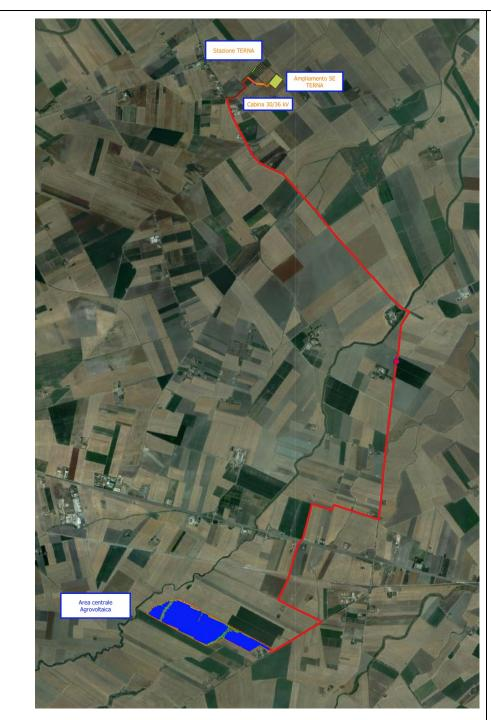
Ortofoto con l'individuazione dell'impianto in progetto, del cavidotto MT e della stazione Terna S.p.A. con relativo ampliamento da realizzarsi.
