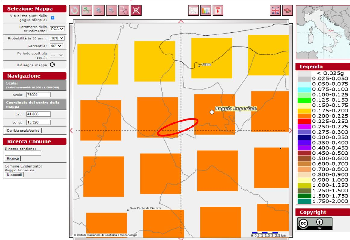
Figura 18: - Mappa dell'accelerazione massima al suolo con probabilità di eccedenza del 10% in 50 anni riferita a suoli rigidi ( $V_{s30} > 800\text{m/s}$  Cat. A).
