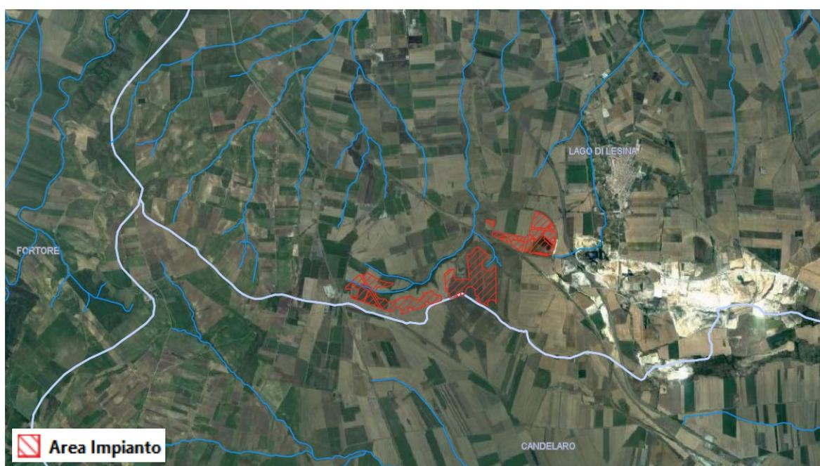
Figura 7: – Stralcio dell'idrografia e bacini idrografici principali dell'area di progetto
