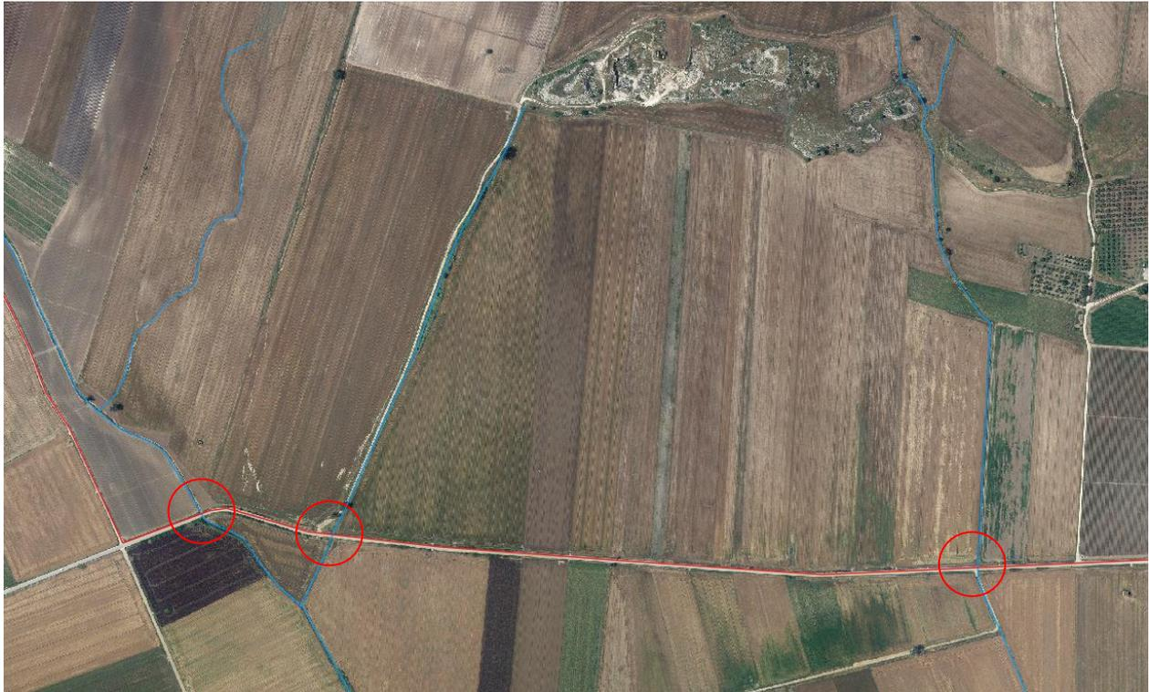
**Figura 15** – Dettaglio intersezioni tra il cavidotto e il reticolo idrografico
