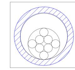
Max 4 circuiti 10mmq H1Z2Z2-K in Ø50mm Dimensionato secondo la norma CEI 64-8
