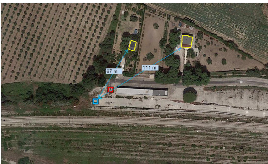
Figura 6-16: Distanze tra antenna nella nuova collocazione (riquadro azzurro) e edifici (in giallo) presenti in prossimità dell'area d'intervento. in rosso l'antenna nella sua attuale posizione (riquadro rosso)
