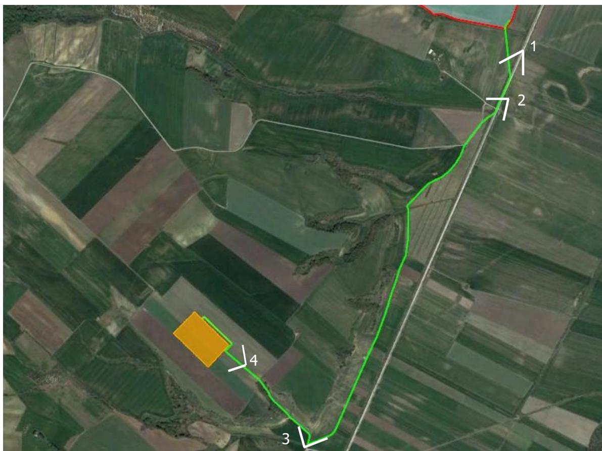
*Vista d'insieme campo per stazione di trasformazione (punto di connessione) e percorso elettrodotto con punti di scatto*
