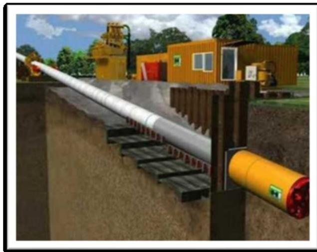
Figure 2-11. Schema tecnica "Microtunneling"
