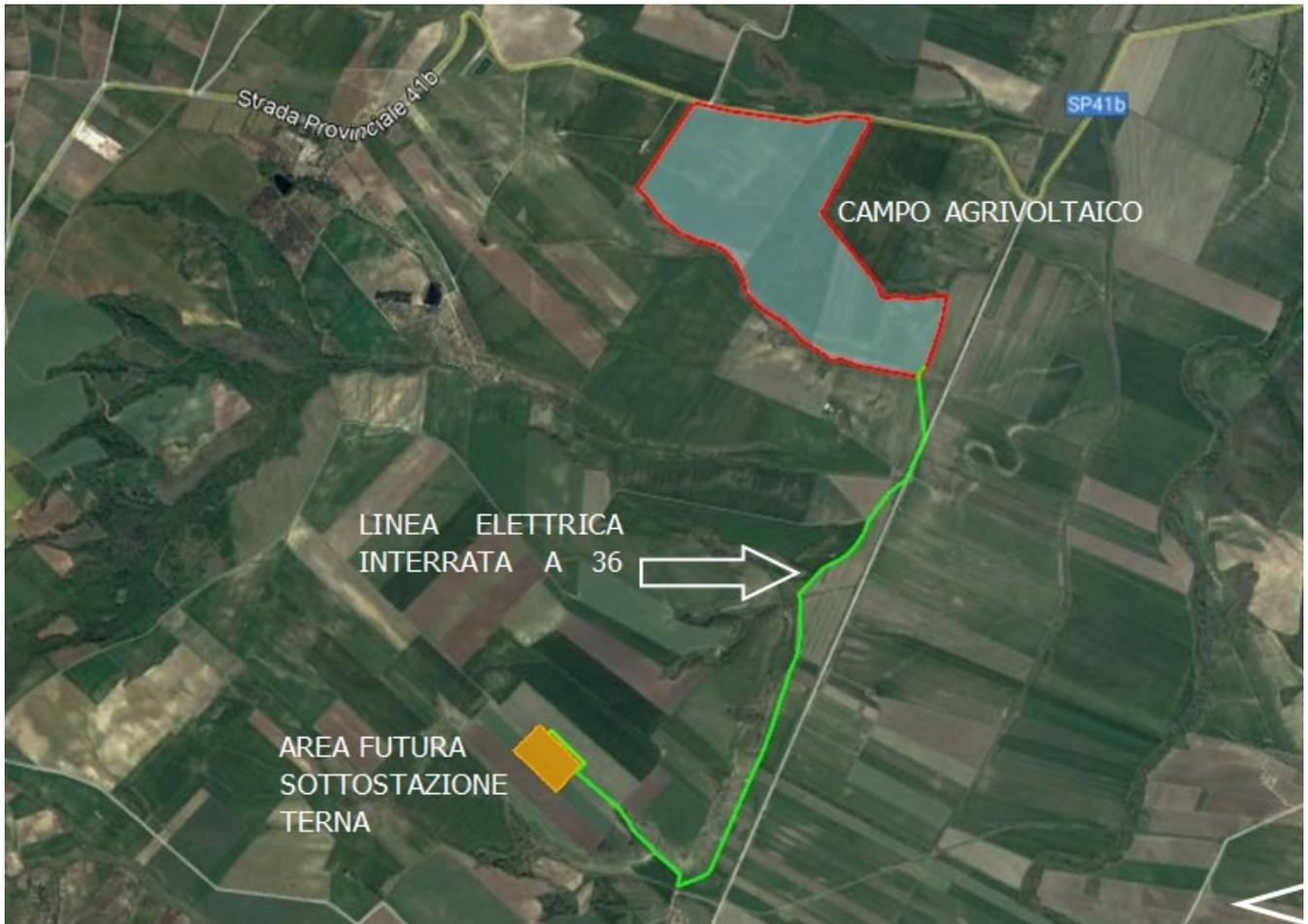
Figure 2-4. Vista d'insieme dell'impianto con collegamento cavo a 36 kV (in verde)
