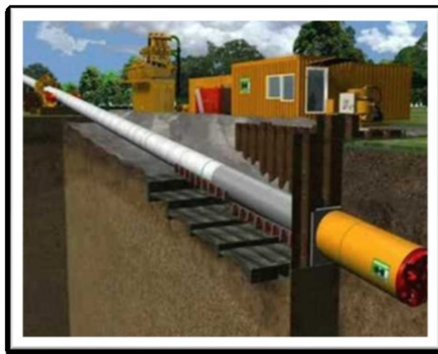
Figure 1-11. Schema tecnica "Microtunneling"
