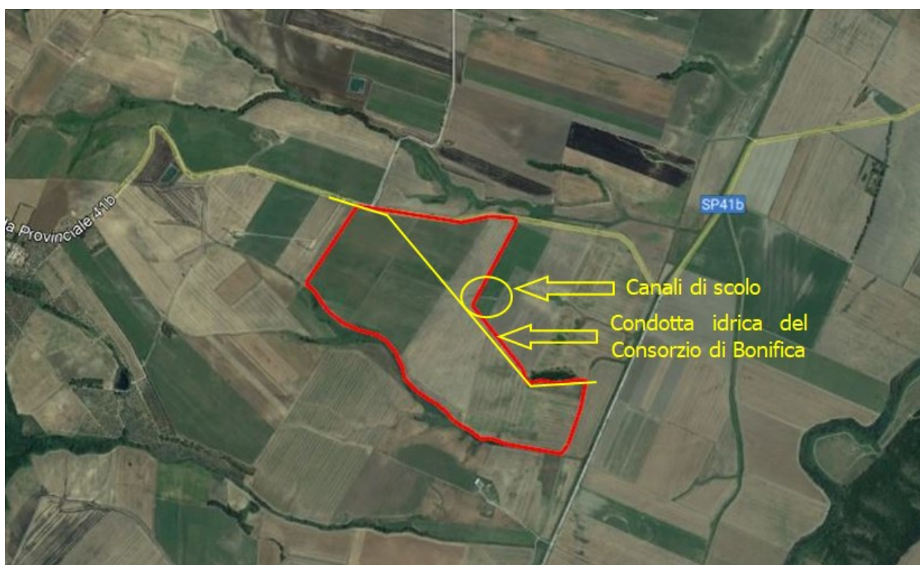
Figure 1-13. Area d'interesse – Interferenze rilevate
