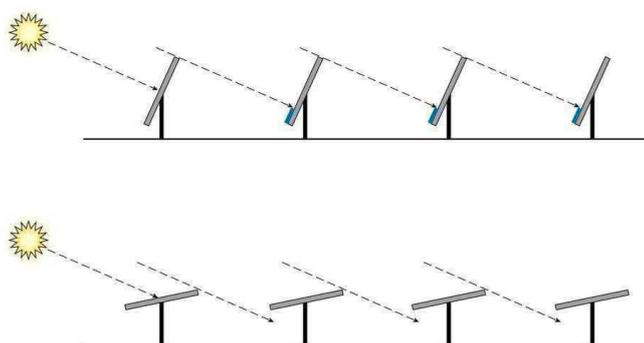
Il localizzatore orizzontale monoassiale ipotizzato, utilizza dispositivi elettromeccanici, che gli consentono di seguire il sole durante tutto il giorno da Est a Ovest sull'asse di rotazione orizzontale Nord-Sud (inclinazione 0°). I layout di campo con inseguitori monoasse orizzontali sono molto flessibili. La semplice geometria permette di mantenere tutti gli assi di rotazione paralleli l'uno all'altro in modo da posizionare opportunamente i tracker l'uno rispetto all'altro.
