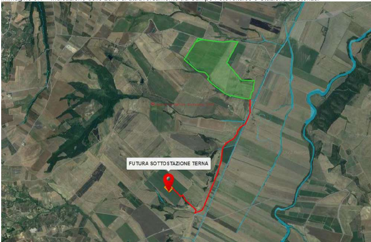
Immagine 9.1 – Indicazione delle zone di attraversamento tra Campo Fotovoltaico e Stazione di Utenza.
