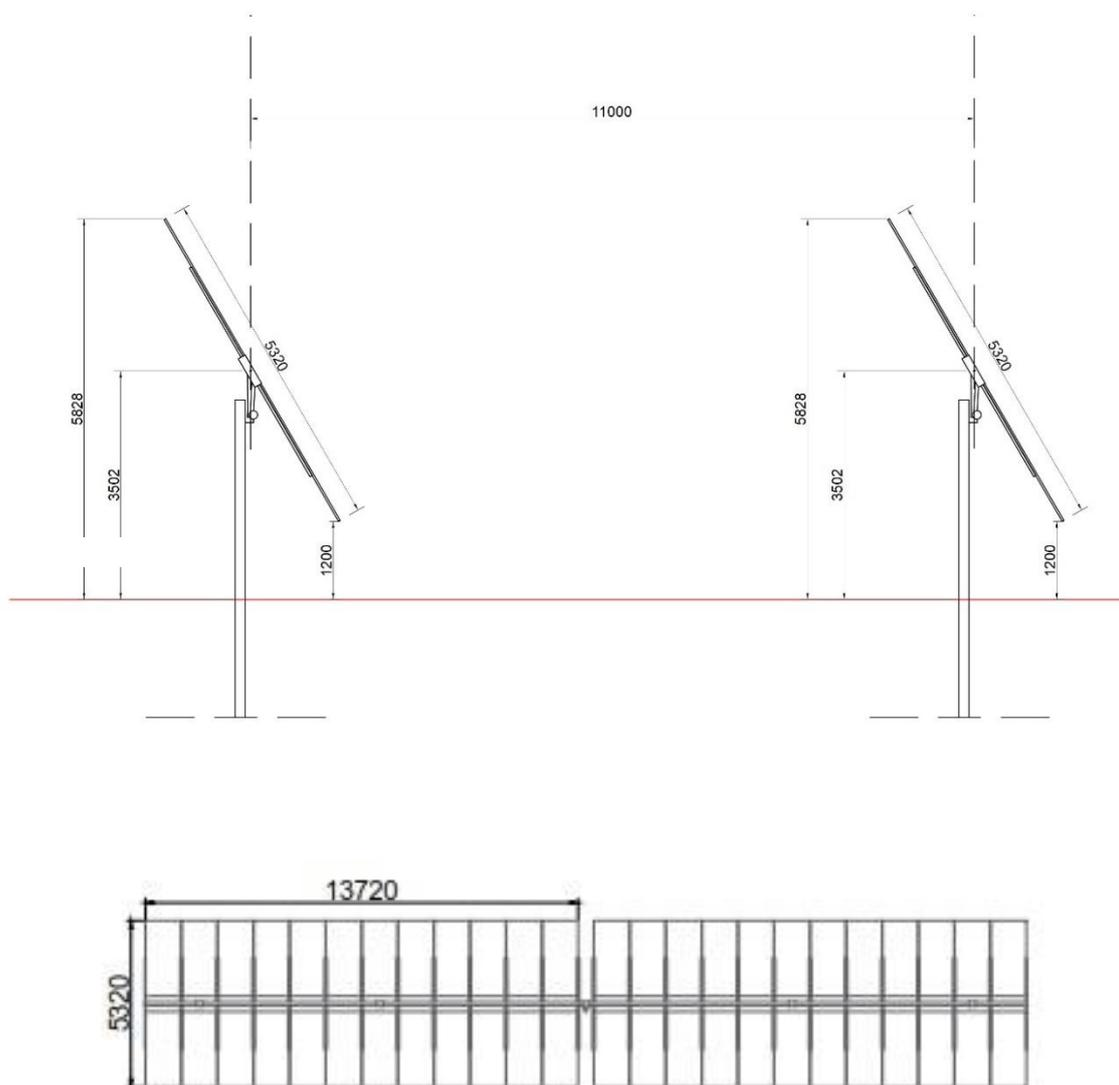
*Vista laterale e in pianta di due stringhe fotovoltaiche*
