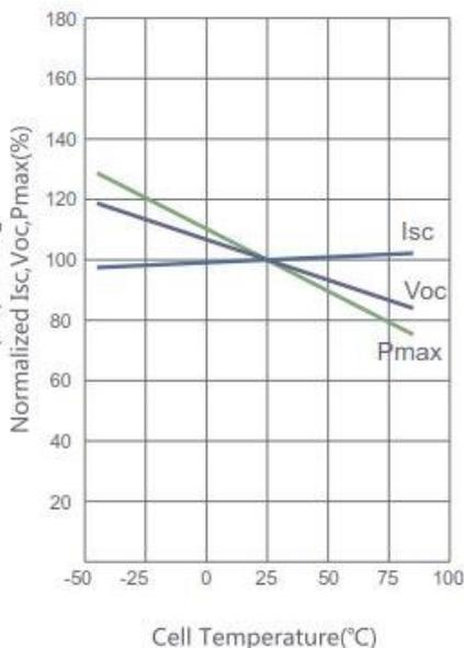
*Modulo fotovoltaico – parametri elettrici*
