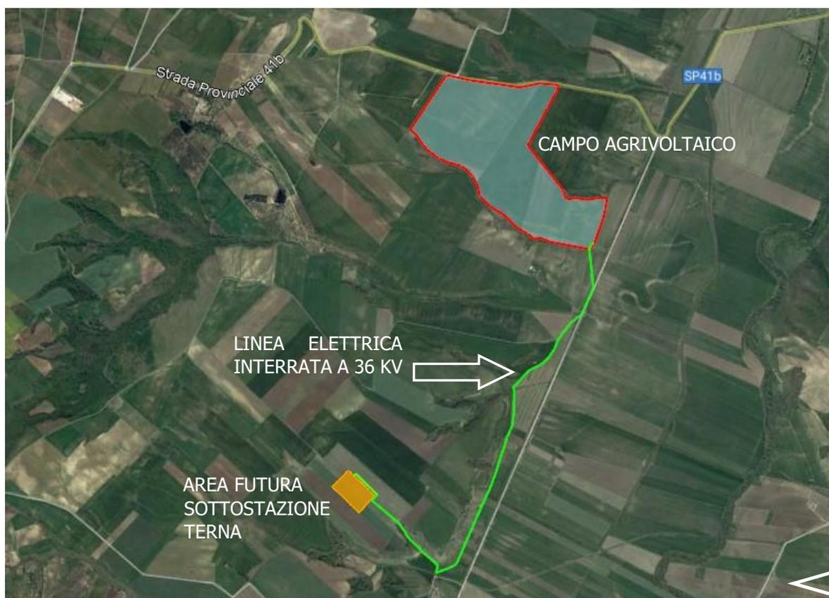
*Vista d'insieme dell'impianto con collegamento cavo a 36 kV (in verde)*
