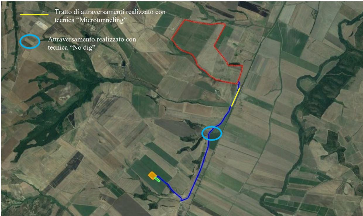
Figura 0-19 Individuazione tratti attraversati con tecniche "no dig" e "microtunneling"
