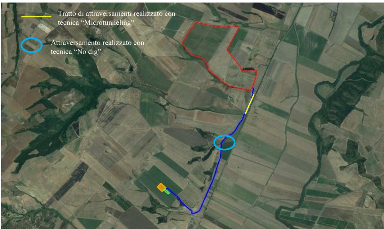
Figura 0-9 Individuazione tratti attraversati con tecniche “no dig” e “microtunneling”
