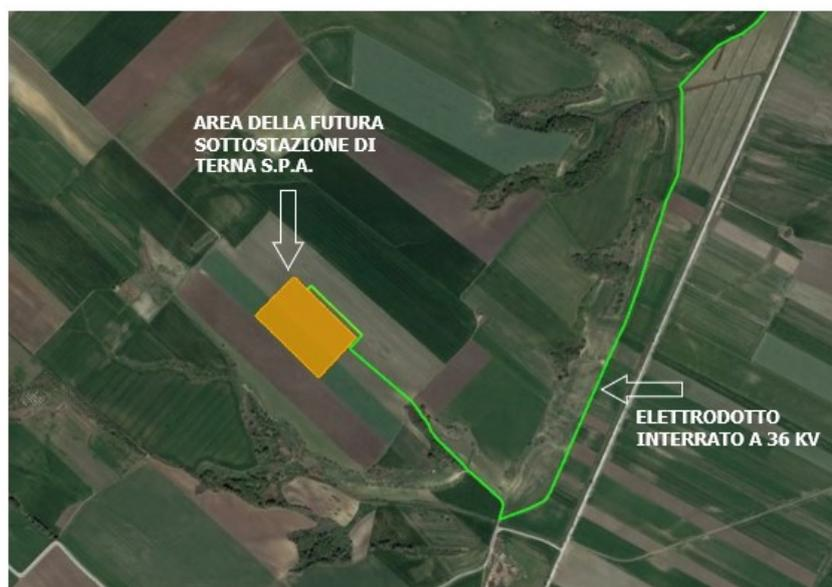
*Figura 8: Vista d'insieme della Sottostazione di trasformazione*
