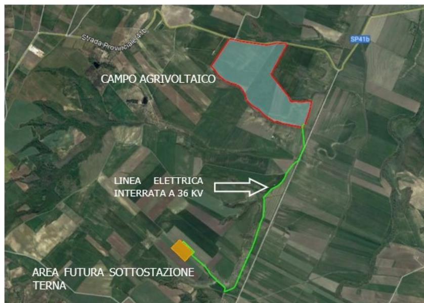
Figura 7: Vista d'insieme dell'impianto con collegamento cavo a 36 kV (in verde)
