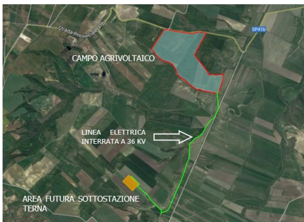
Figura 15: Vista d'insieme dell'impianto con collegamento cavo a 36 kV (in verde)
