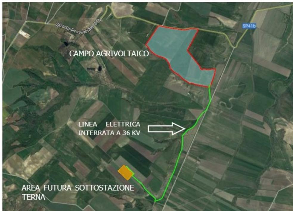
Figura 2-5: Vista d'insieme dell'impianto con collegamento cavo a 36 kV (in verde)
