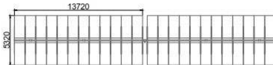
Figura 4-6. Vista laterale e in pianta di due stringhe fotovoltaiche
