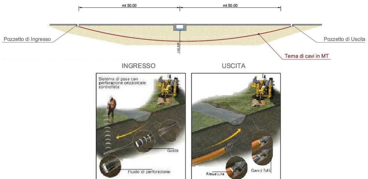
Figure 5-2. Tecnica No Dig
