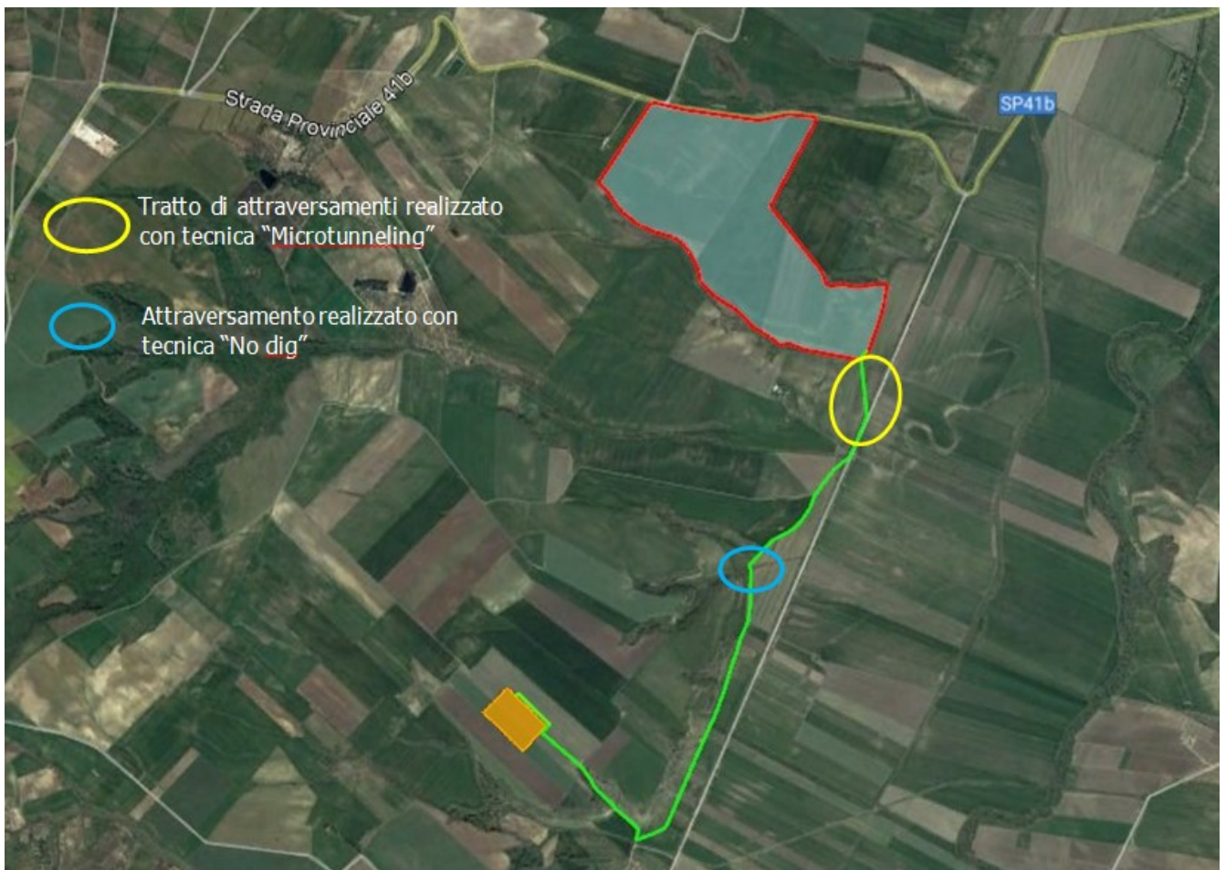
Figure 2-20. Individuazione tratti attraversati con tecniche "no dig" e "microtunneling"
