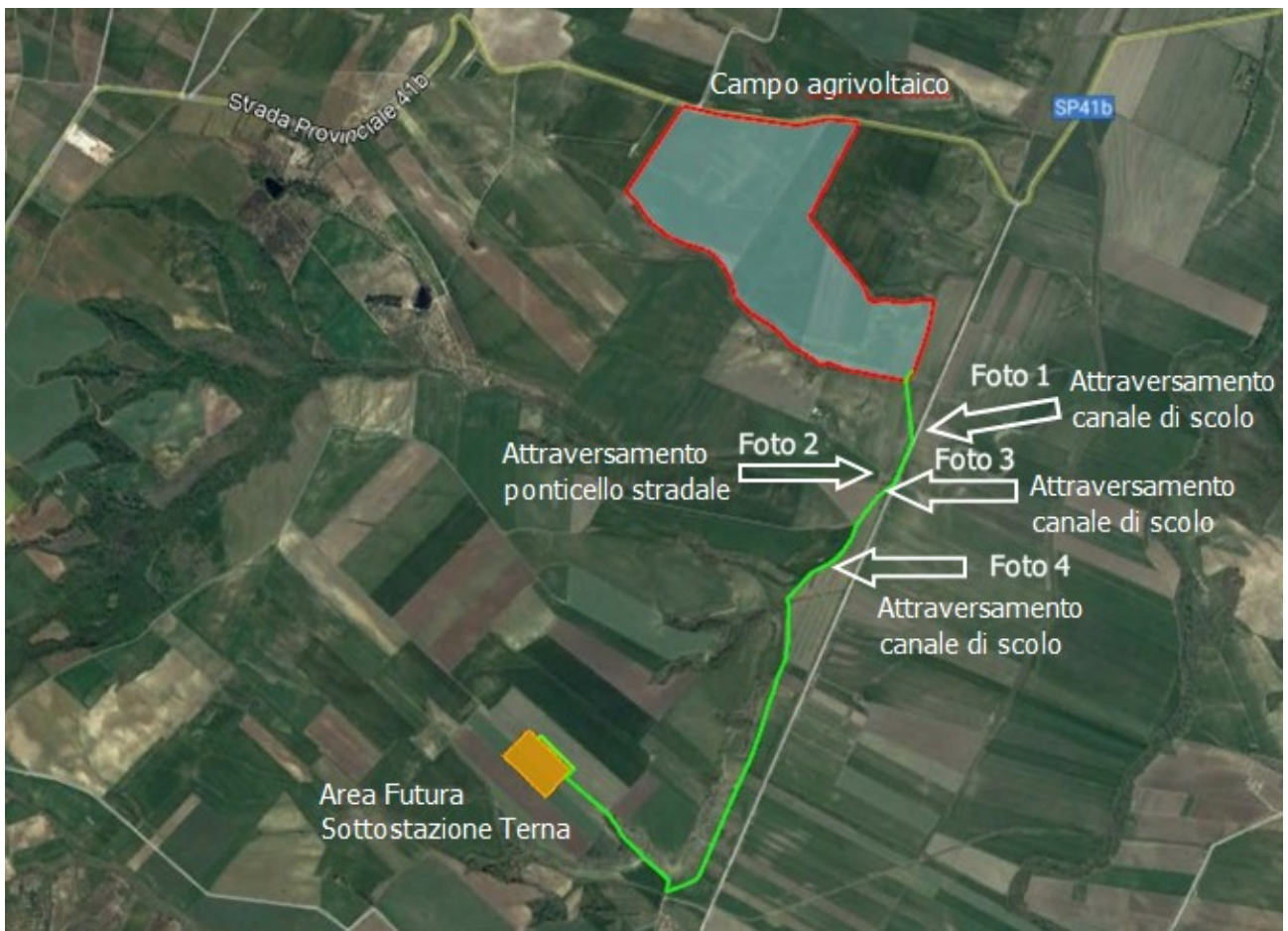
Figura 5-2. Interferenze rilevate al tracciato del cavidotto.
