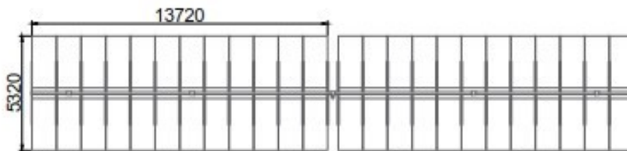
Figure 2-6. Vista laterale e in pianta di due stringhe fotovoltaiche
