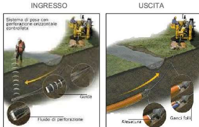
Figura 3-9 Tecnica No Dig
