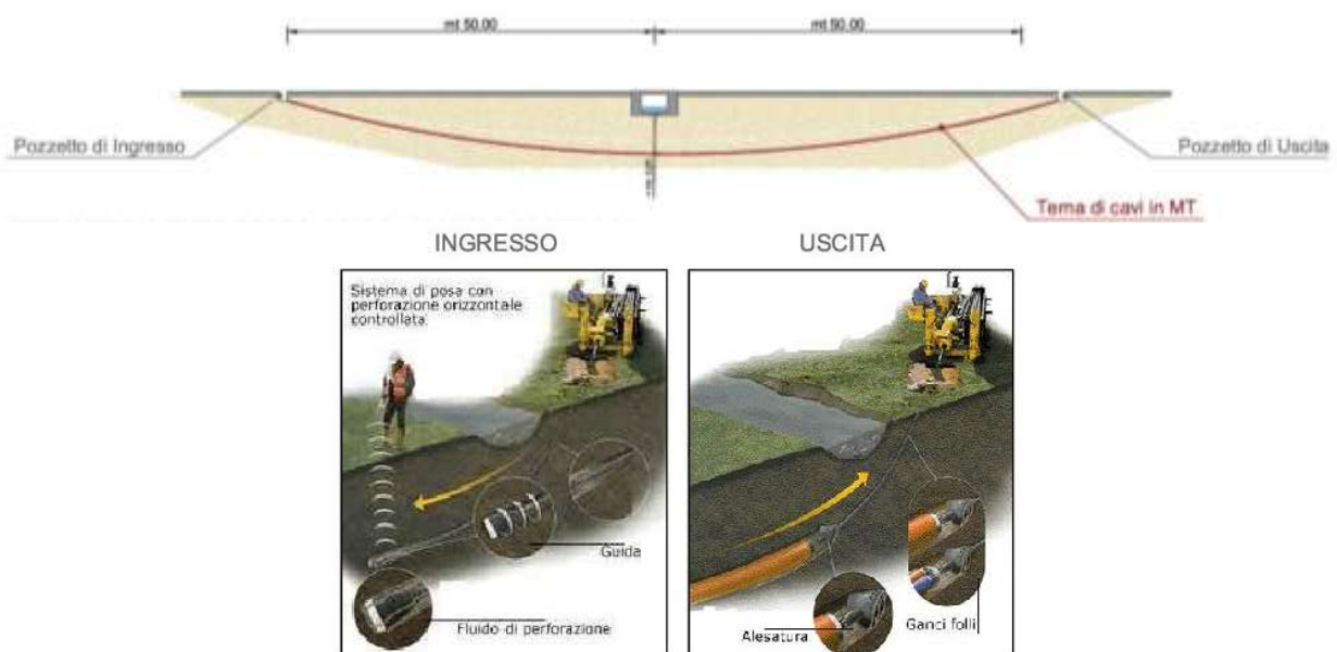
Figura 4-3 Tecnica No Dig
