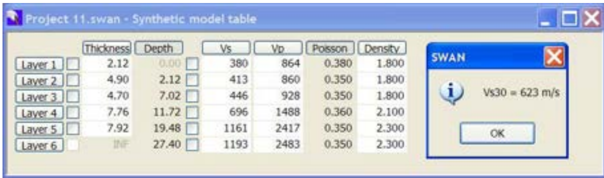
Fig. 2.5-5: STIMA VELOCITA' Vs30 – MASW S08
