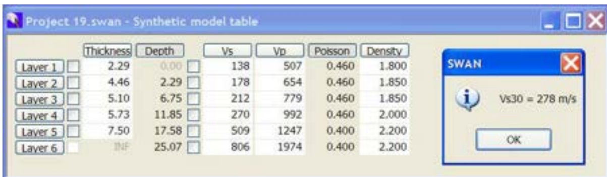
Fig. 2.5-19: STIMA VELOCITA' Vs30 – MASW S34
