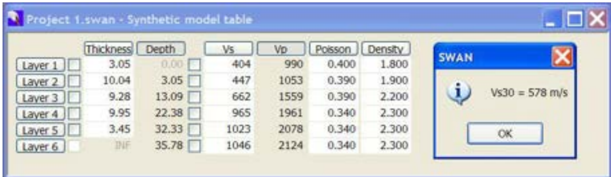
Fig. 2.5-2: STIMA VELOCITA' Vs30 – MASW S02
