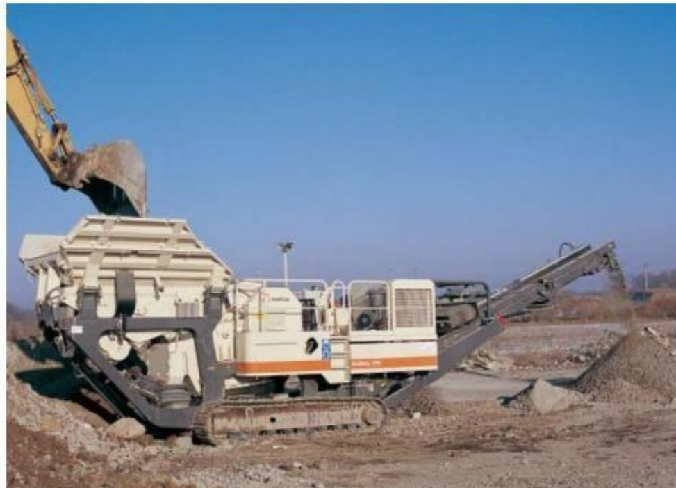
Figura 28. Esempio impianto di frantumazione mobile
