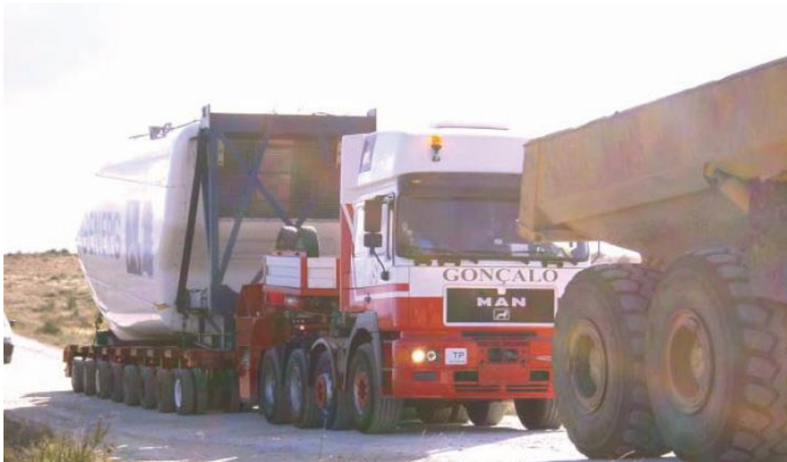
Figura 13. - Trasporto navicella su viabilità di sito/cantiere con mezzi modulari
