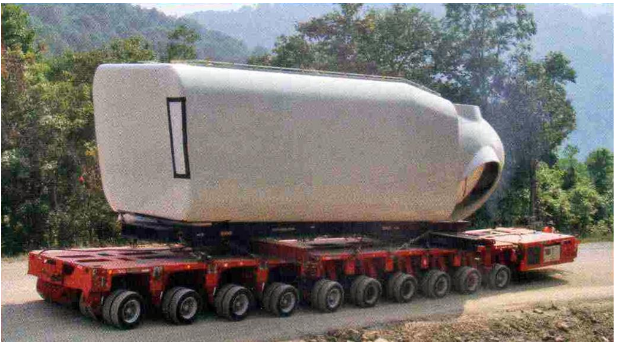
Figura 19. - Trasporto di navicella su carrello semovente modulare per curve a ridotto raggio di curvatura
