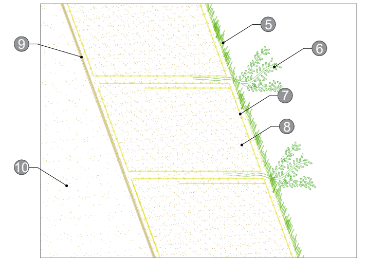
Dettaglio d02 Scarpata inerbita con palificata
