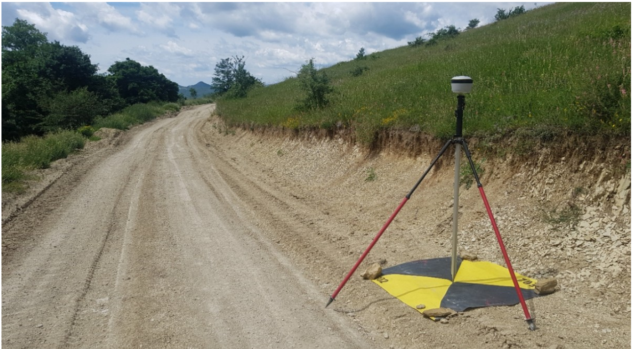
Figura 11. Punto di controllo identificato con target ad alta visibilità e misura GNSS delle sue coordinate.
