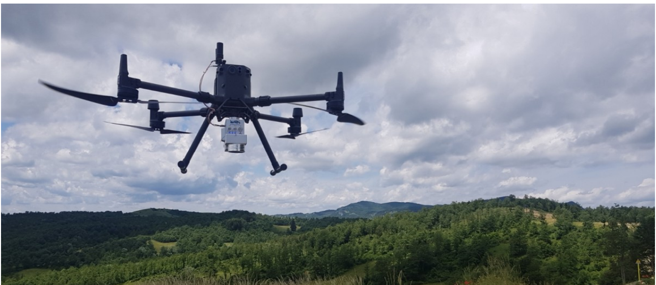
Figura 4. Mezzo aereo DJI Matrice 300 RTK e sensore Lidar LiAirV70
