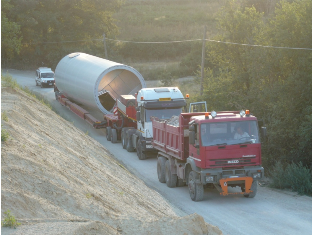
Figura 3-3. Trasporto tramo su viabilità di sito/cantiere con mezzi modulari
