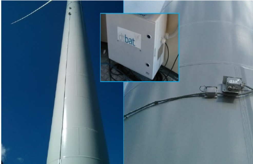
Figura 5-5. I sensori del sistema DTBat® prodotti dalla società Liquen Consultoria Ambientale S.l.
