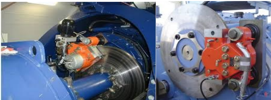
Figura 5-6. Sistemi di freno a disco sull'asse-rotore. Il sistema di controllo DTBird/Bat invia un segnale di frenata del rotore che fa variare il passo delle pale, le pinze bloccano il movimento residuo della rotazione
