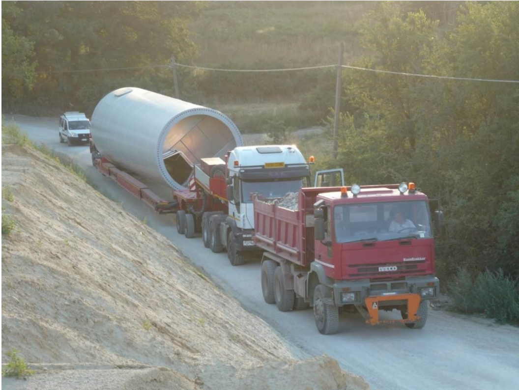
Figura 1-20. Trasporto tramo su viabilità di sito/cantiere con mezzi modulari
