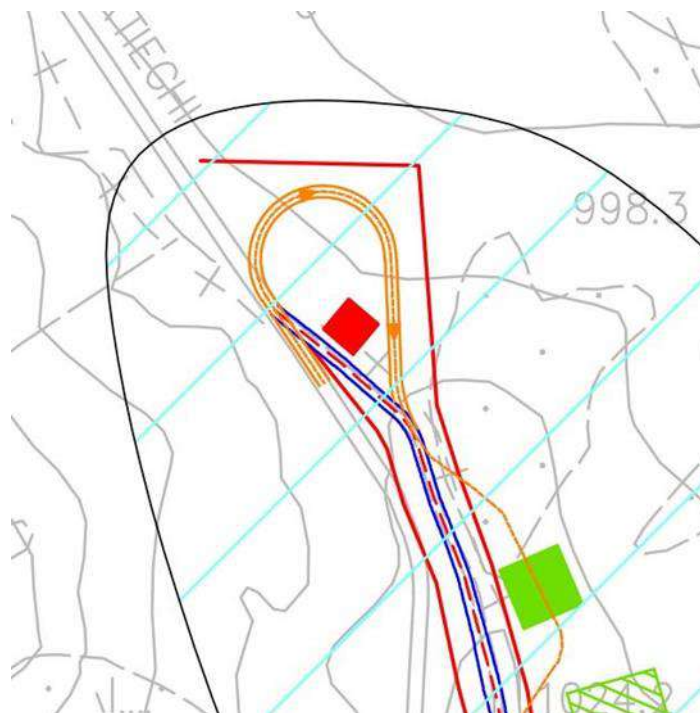
Figura 155. Dettaglio area manovra ingresso parco eolico
