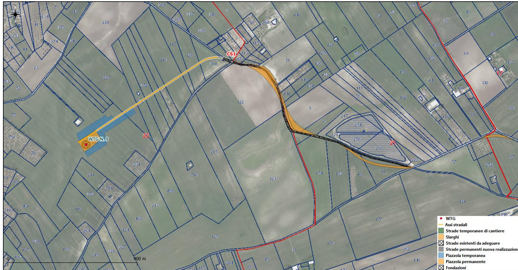
WTG 9: Accesso attraverso strada comunale a sud. Adeguamento della viabilità esistente. Attraverso degli slarghi ad hoc si accede alla WTG 9.
