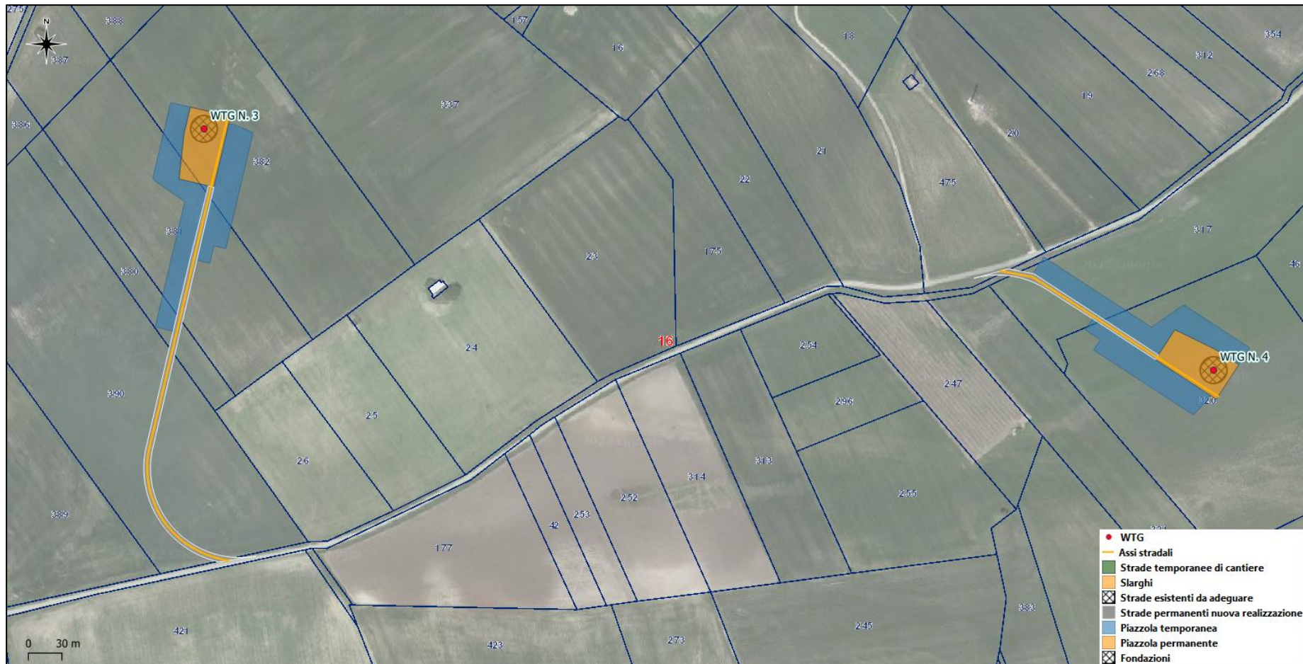
WTG 3 e 4: Accesso da SC
