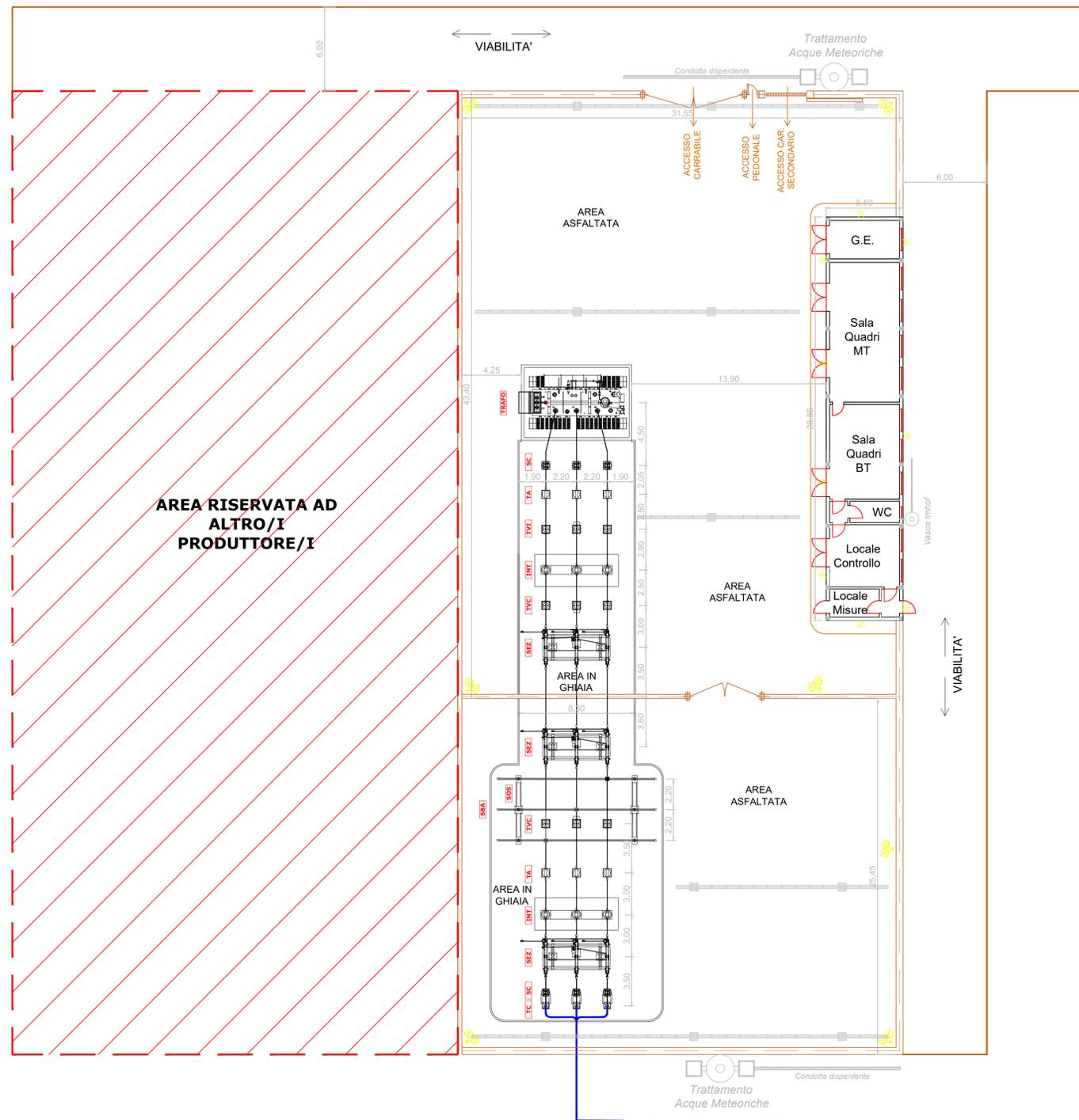
CAVIDOTTO A.T. INTERRATO A 150 kV
