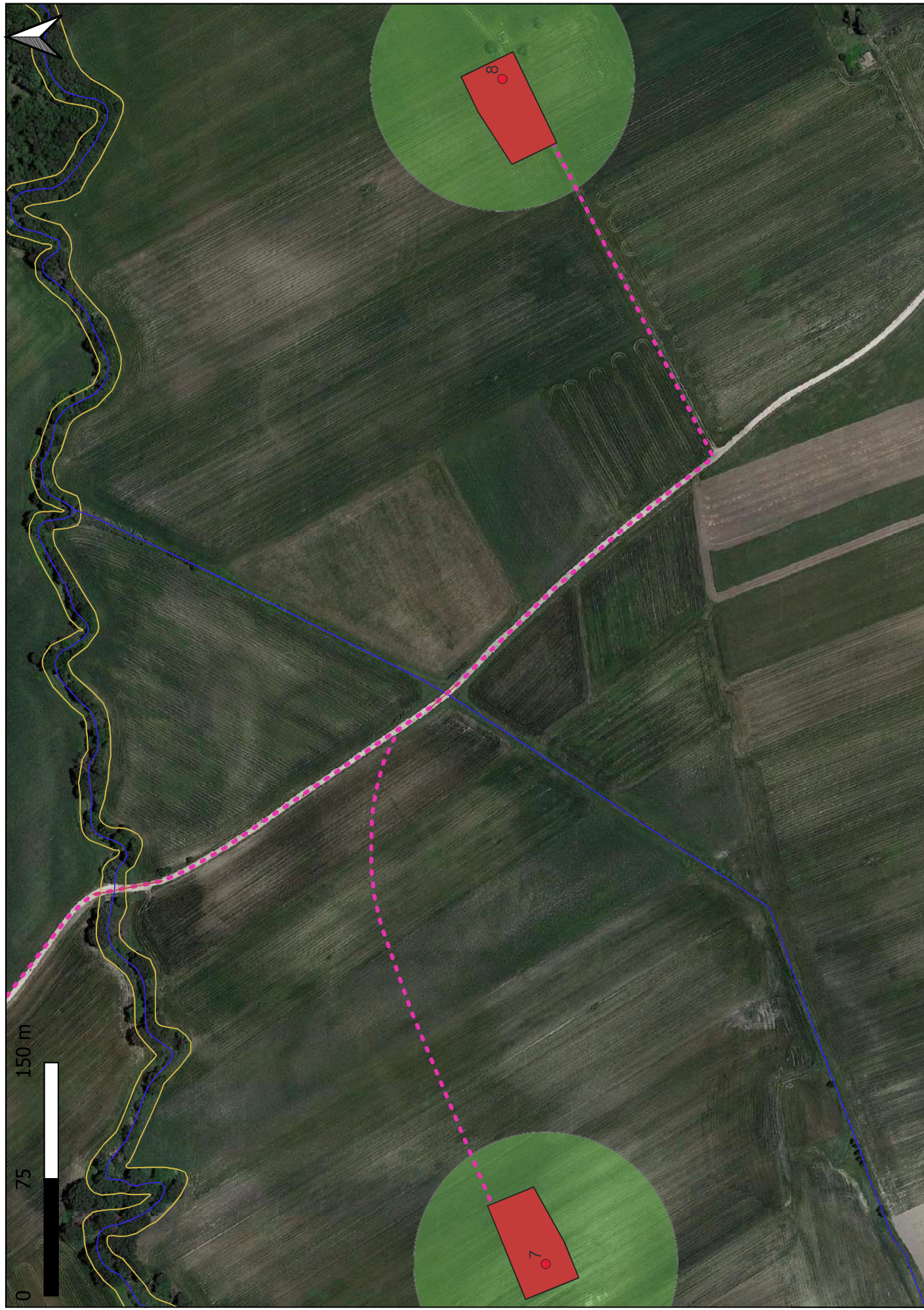
Figura 3.4: Alcuni punti di interferenza cavidotto e reticolo idrografico su stralcio carta idrogeomorfologica della Puglia scala 1:3000
