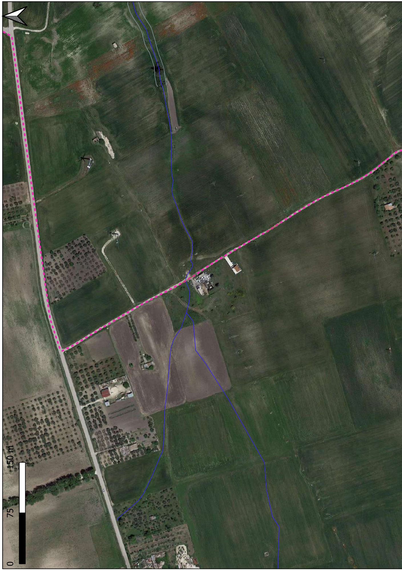
Figura 3.5: Alcuni punti di interferenza cavidotto e reticolo idrografico su stralcio carta idrogeomorfologica della Puglia scala 1:3000
