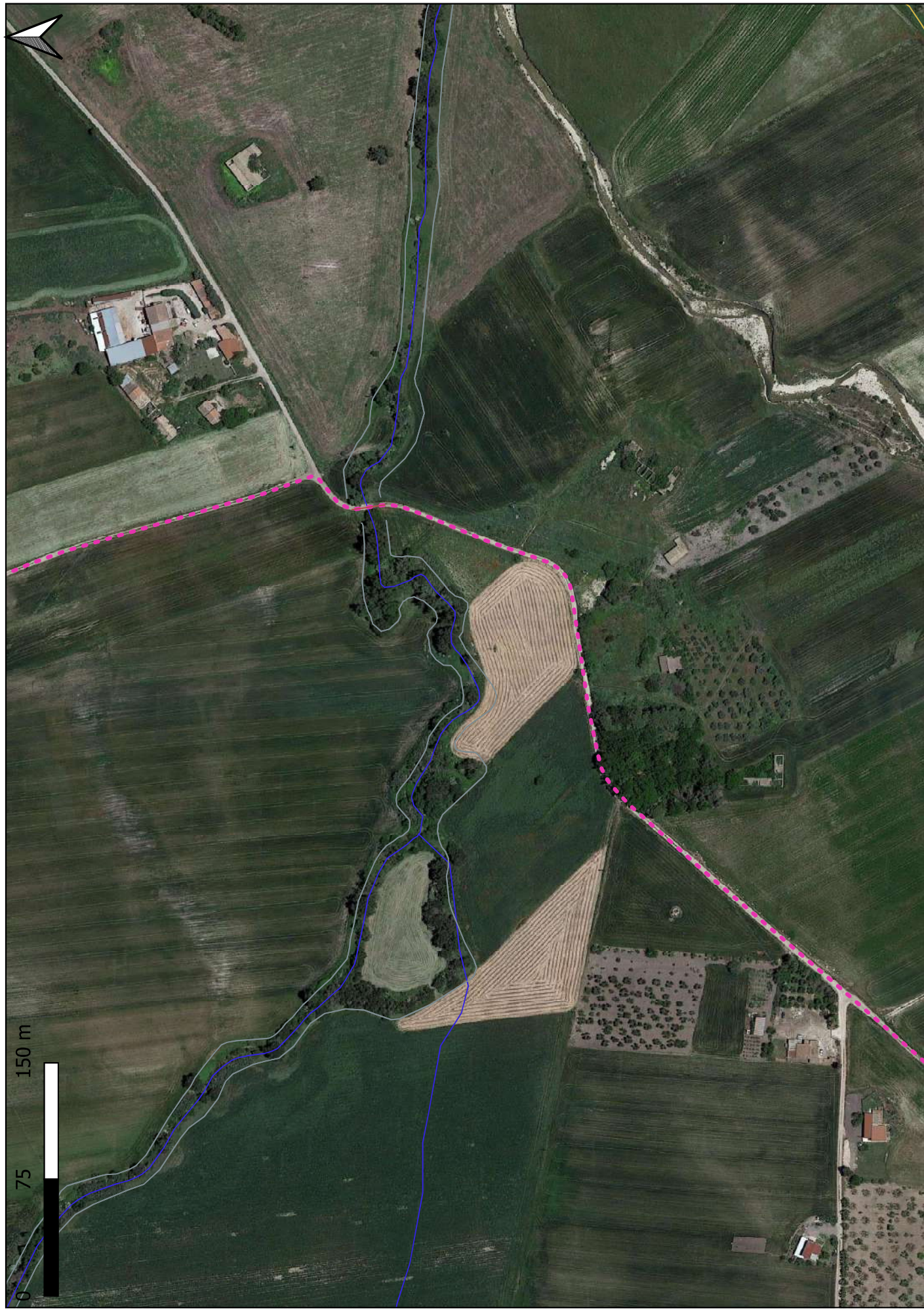
Figura 3.9: Alcuni punti di interferenza cavidotto e reticolo idrografico su stralcio carta idrogeomorfologica della Puglia scala 1:3000
