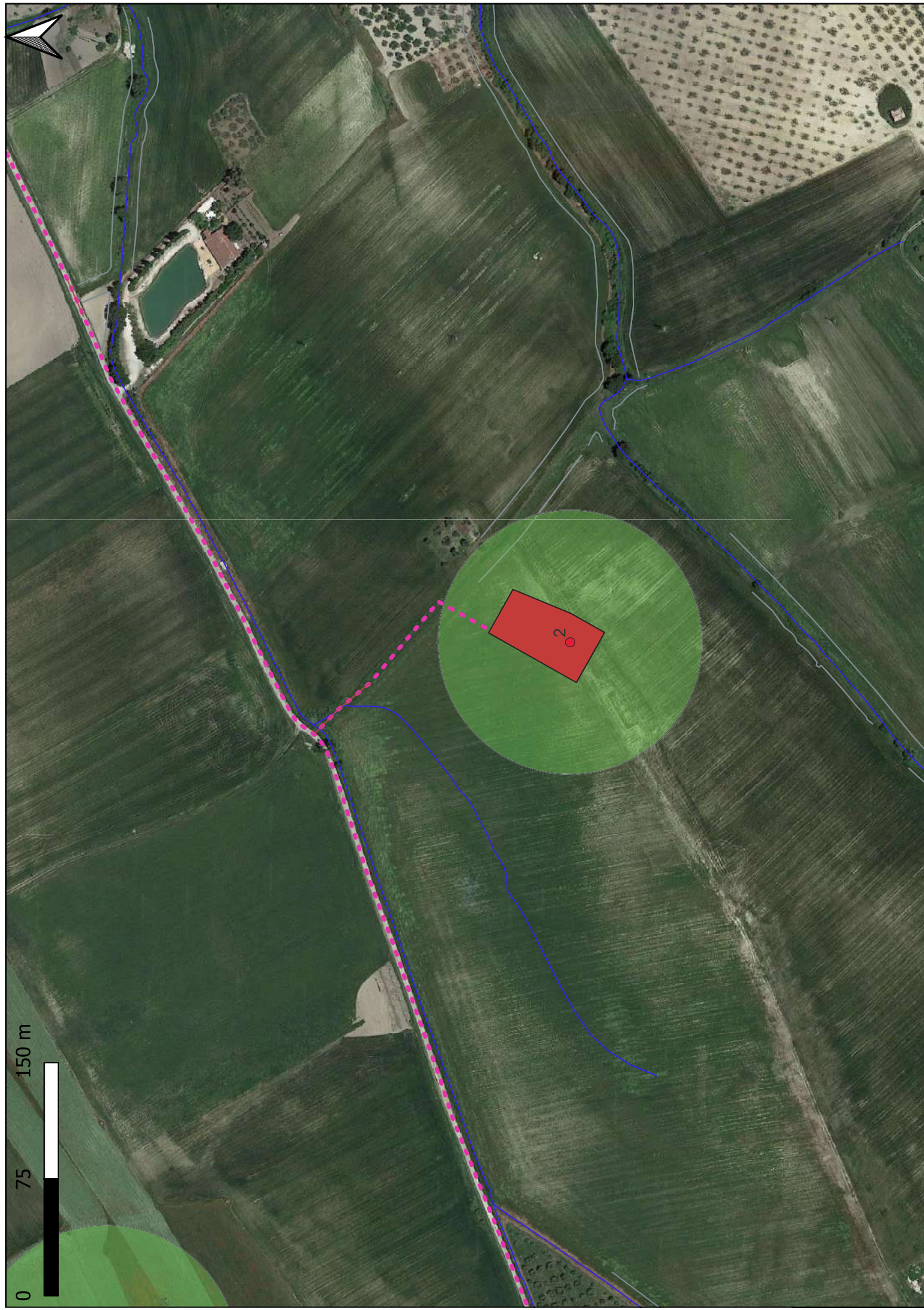
Figura 3.3: Alcuni punti di interferenza cavidotto e reticolo idrografico su stralcio carta idrogeomorfologica della Puglia scala 1:3000
