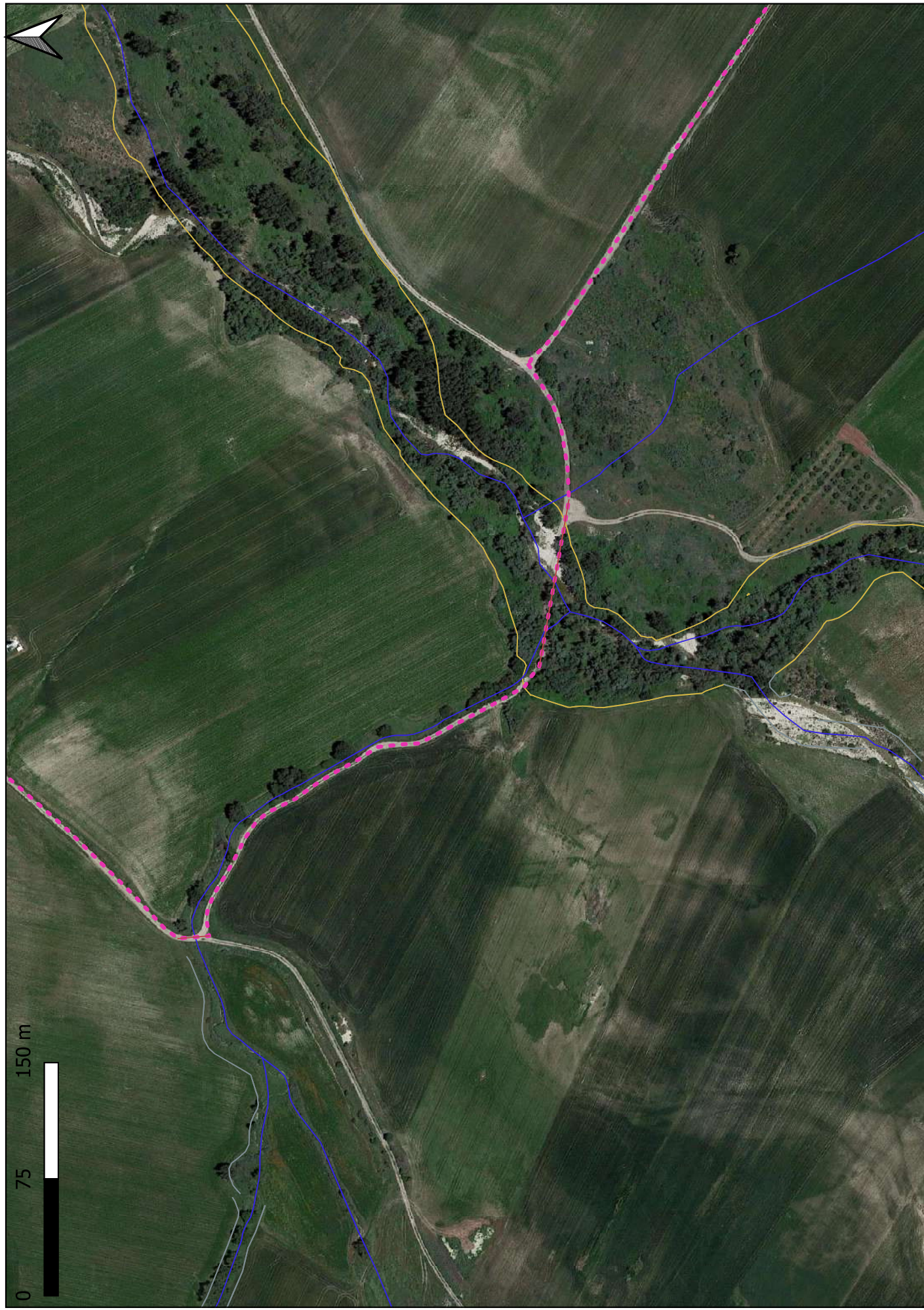
Figura 3.10: Alcuni punti di interferenza cavidotto e reticolo idrografico su stralcio carta idrogeomorfologica della Puglia scala 1:3000
