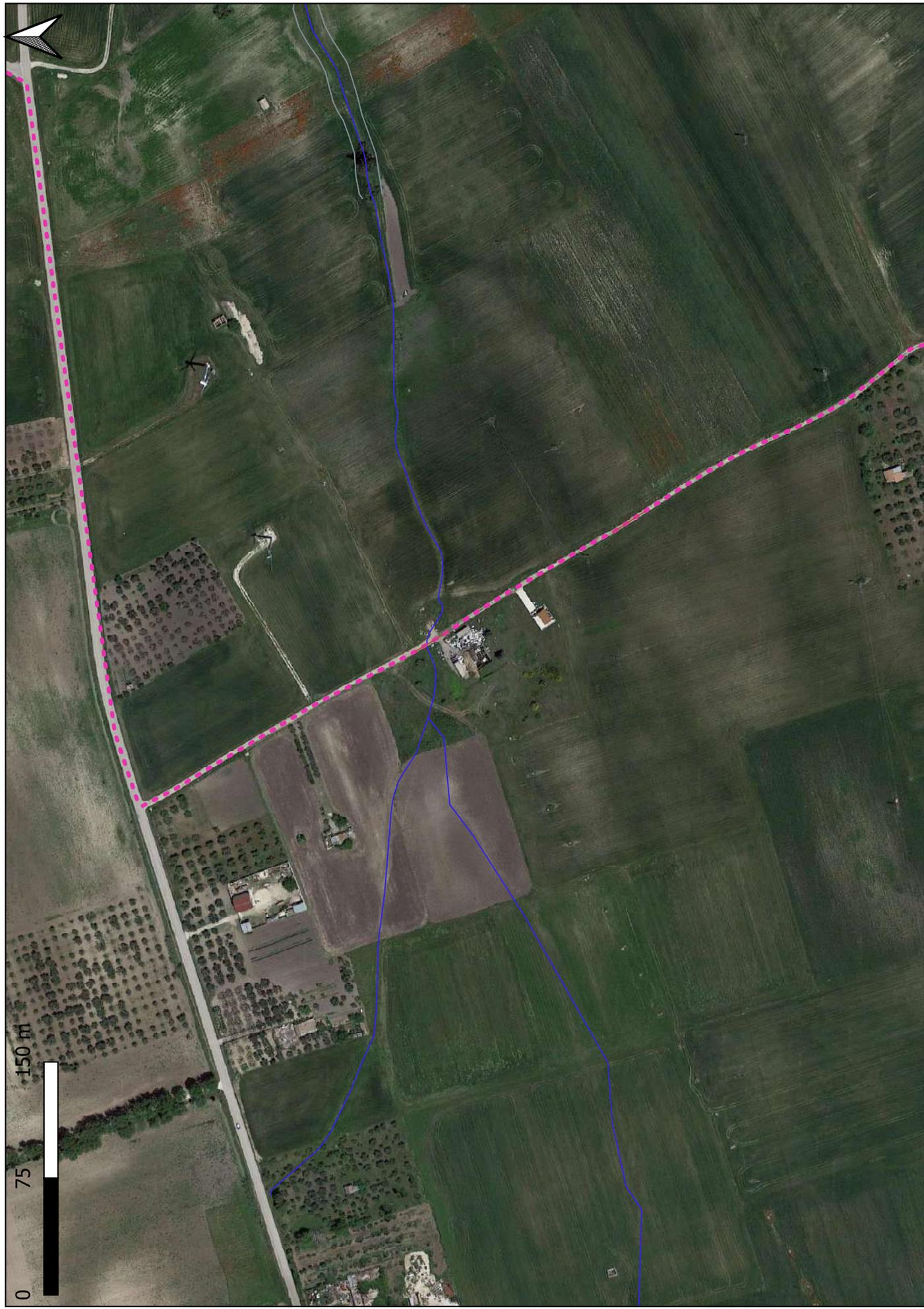
Figura 8.5: Alcuni punti di interferenza cavidotto e reticolo idrografico su stralcio carta idrogeomorfologica della Puglia scala 1:3000
