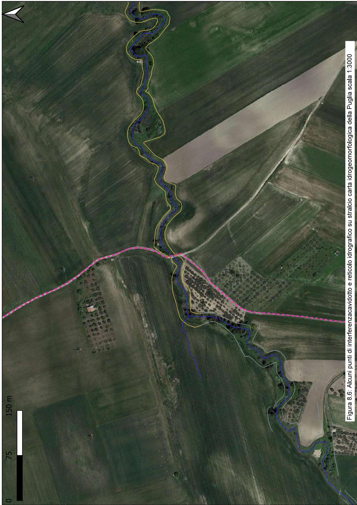
Figura 8.6: Alcuni punti di interferenzacavidotto e reticolo idrografico su stralcio carta idrogeomorfologica della Puglia scala 1:3000
