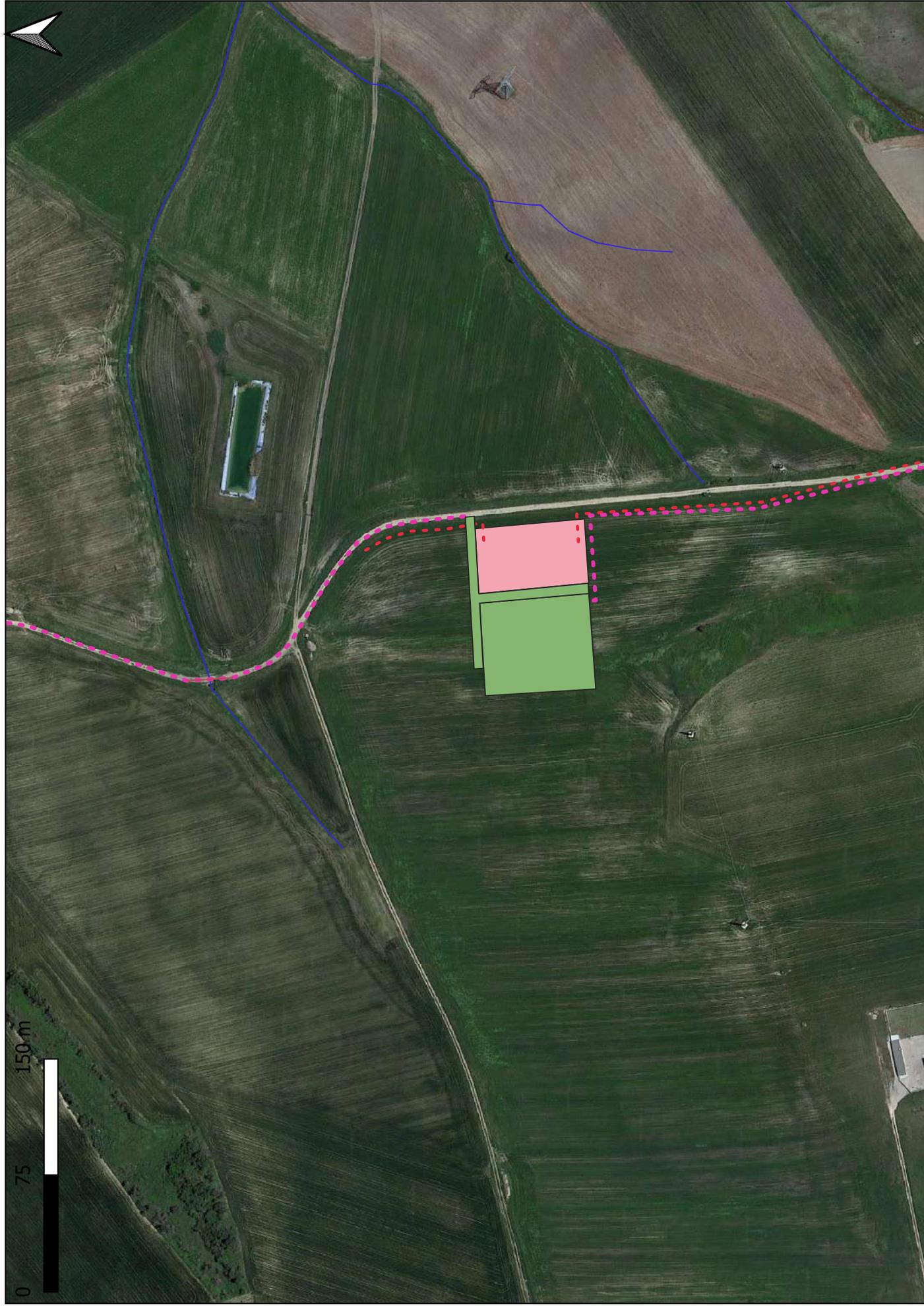
Figura 8.11: Alcuni punti di interferenza cavidotto e reticolo idrografico su stralcio carta idrogeomorfologica della Puglia scala 1:3000
