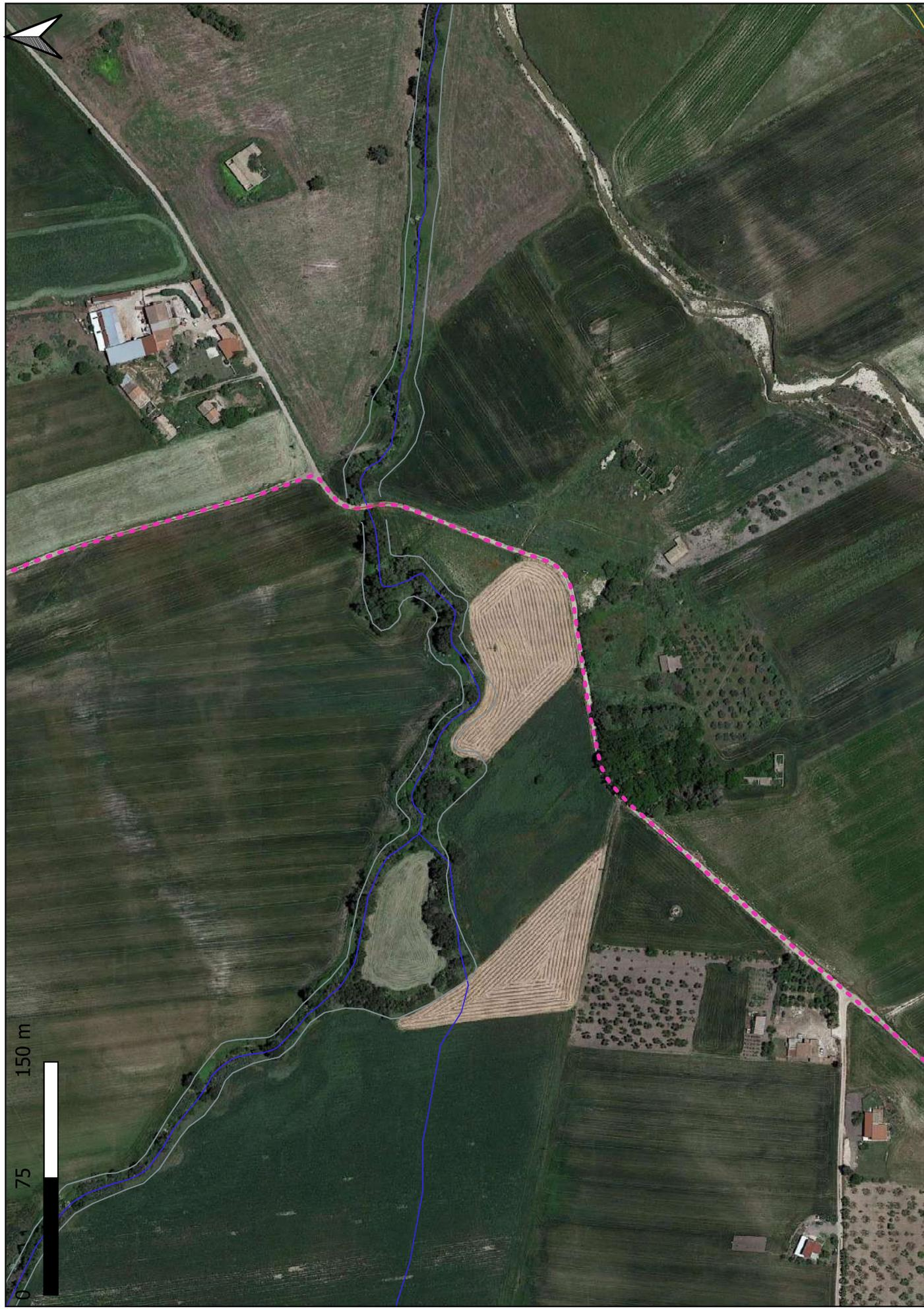
Figura 8.9: Alcuni punti di interferenza cavidotto e reticolo idrografico su stralcio carta idrogeomorfologica della Puglia scala 1:3000
