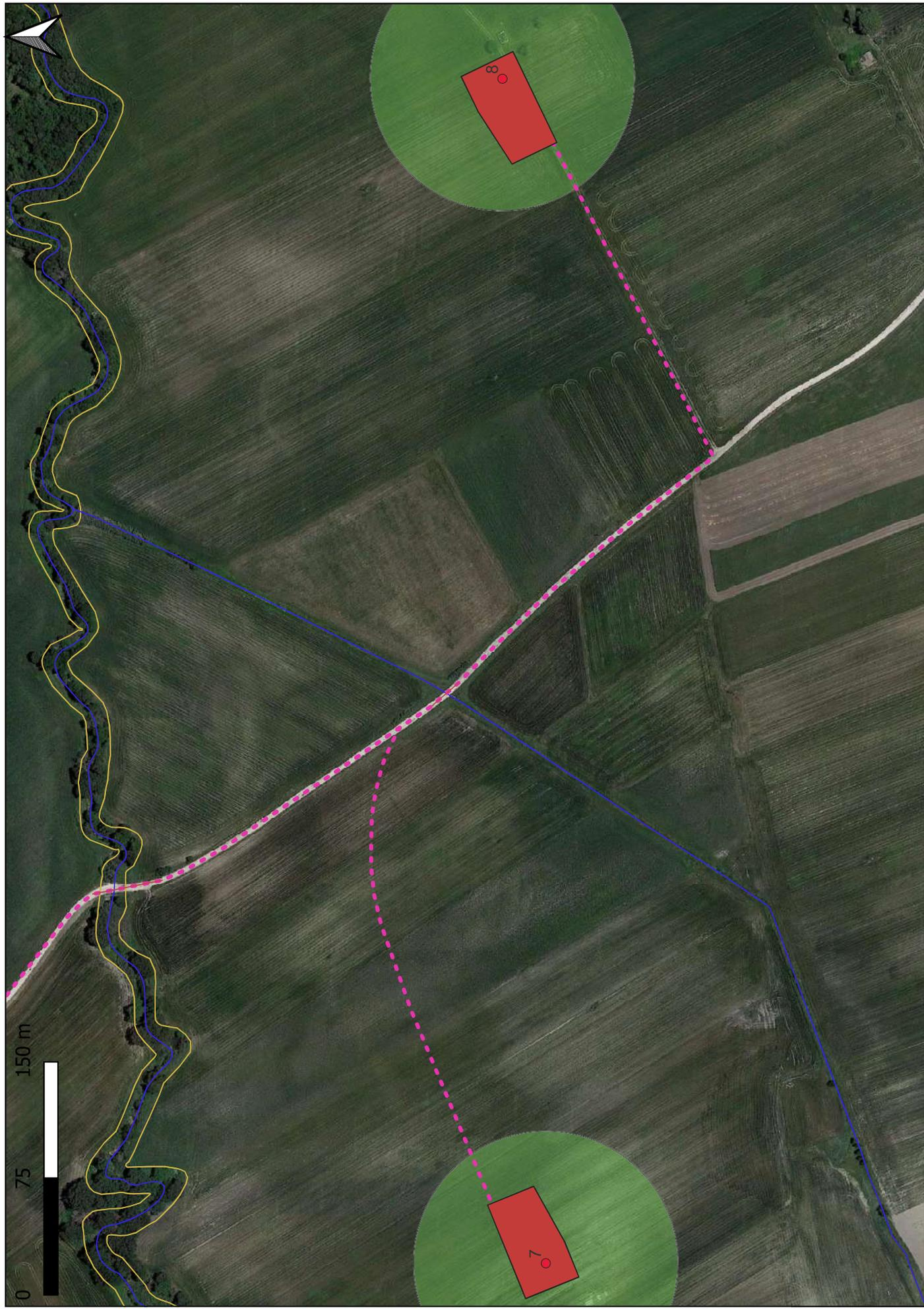
Figura 8.4: Alcuni punti di interferenzacavidotto e reticolo idrografico su stralcio carta idrogeomorfologica della Puglia scala 1:3000
