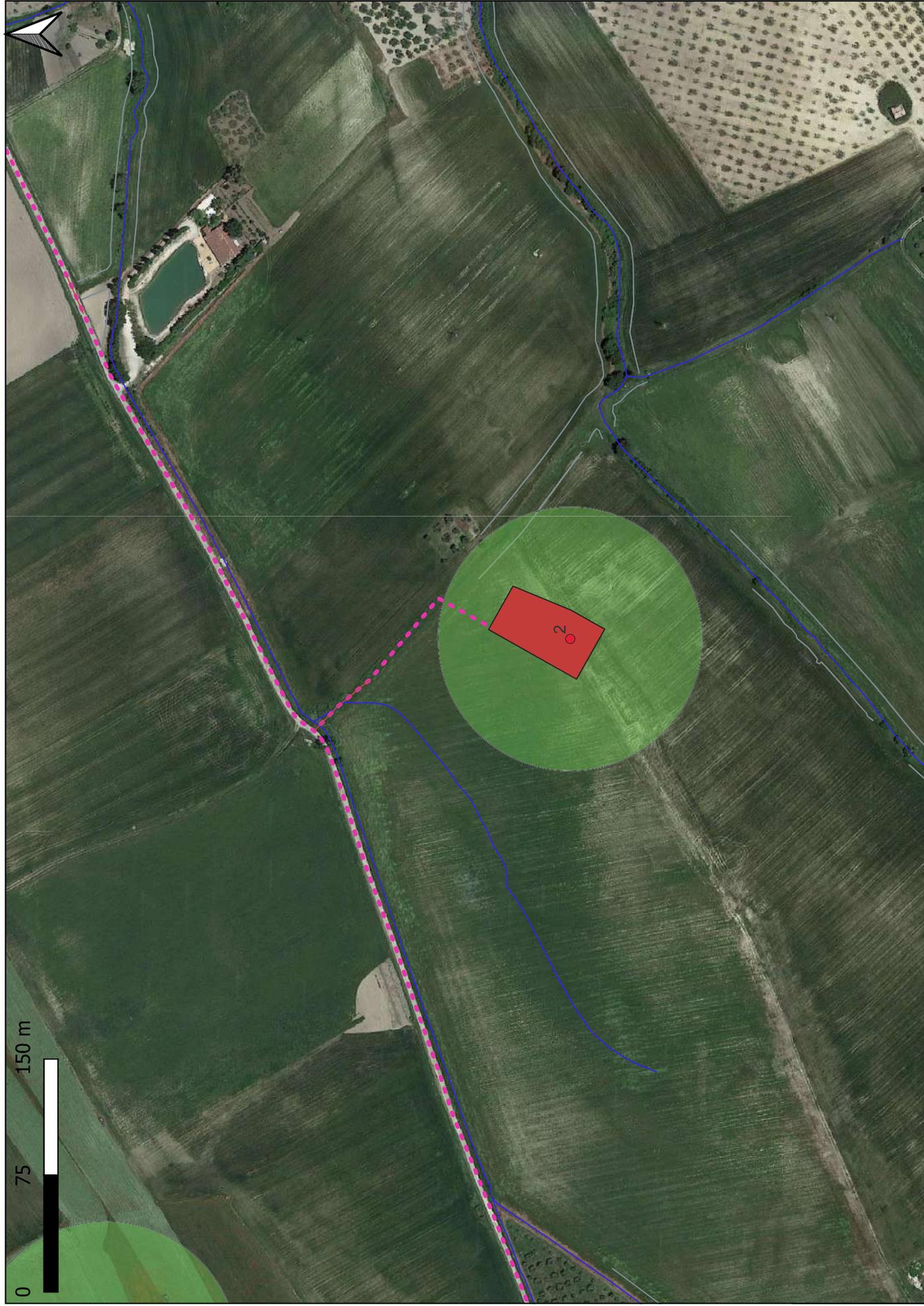
Figura 8.3: Alcuni punti di interferenza cavidotto e reticolo idrografico su stralcio carta idrogeomorfologica della Puglia scala 1:3000
