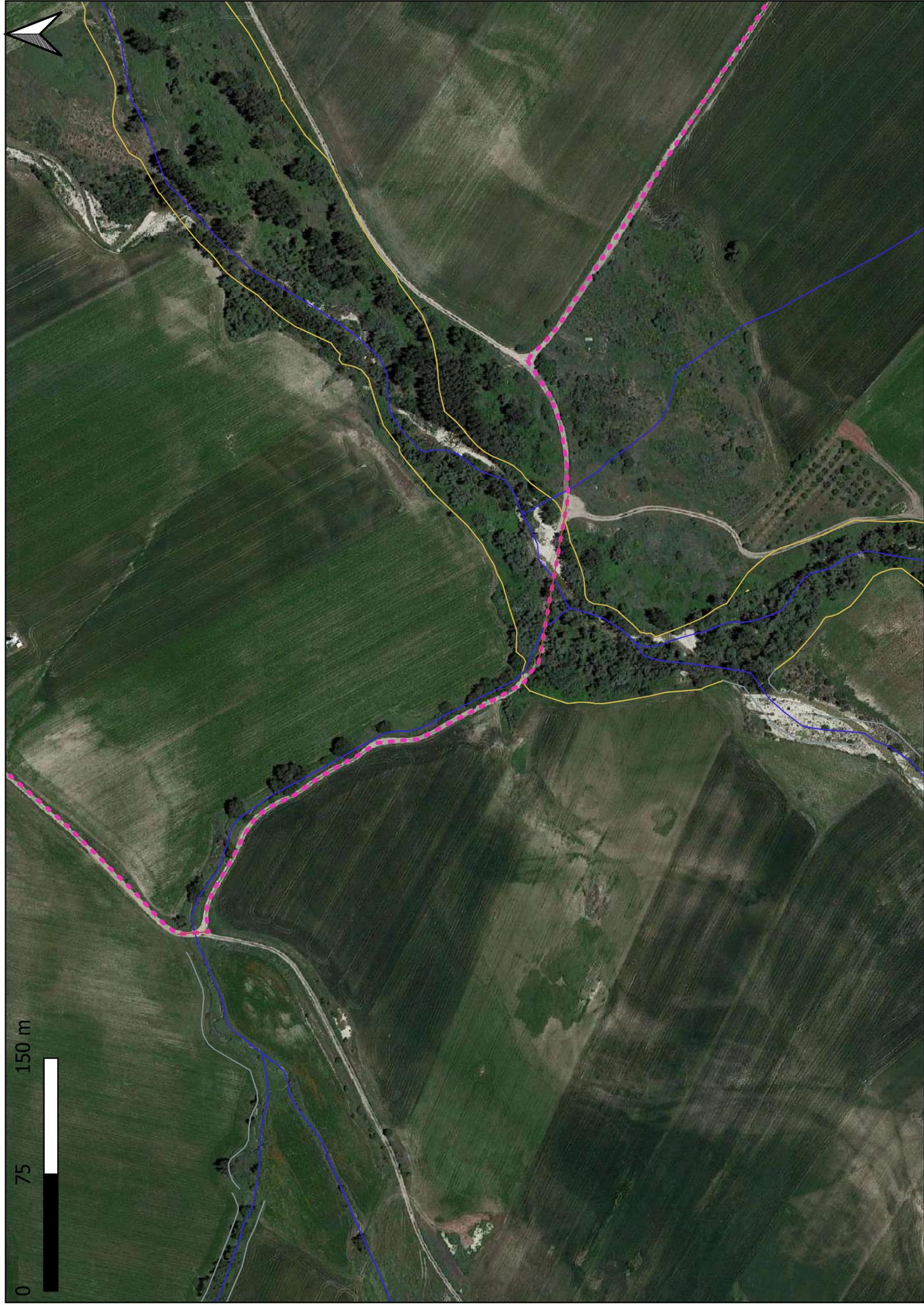
Figura 8.10: Alcuni punti di interferenza cavidotto e reticolo idrografico su stralcio carta idrogeomorfologica della Puglia scala 1:3000
