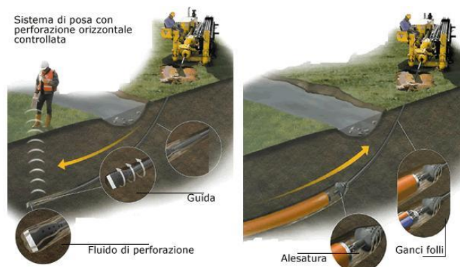
Fig. 1.13: Posa in opera tubazione per alloggio cavi
