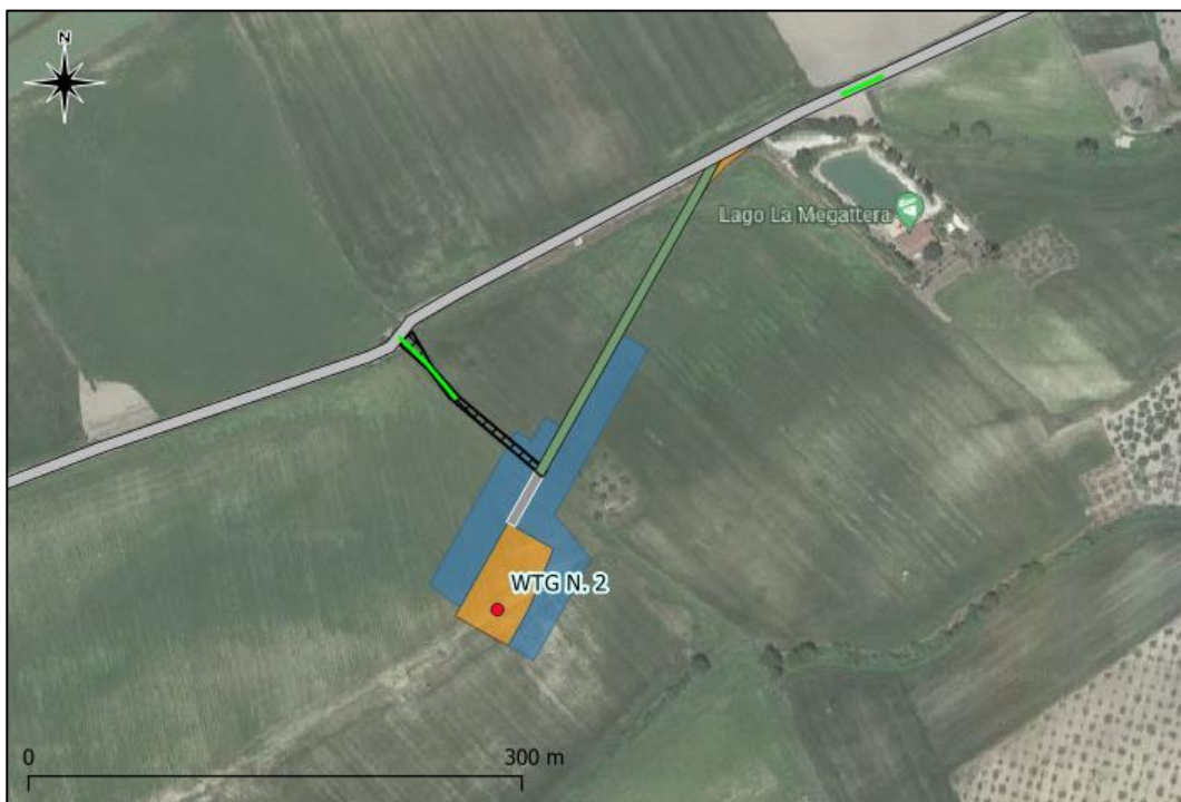
WTG 2 – Piazzola temporanea (in blu), permanente (in arancione), viabilità di accesso (in grigio), viabilità di accesso temporanea di cantiere (in verde) e viabilità di accesso da adeguare (in nero) con tratto in TOC (colore verde)
