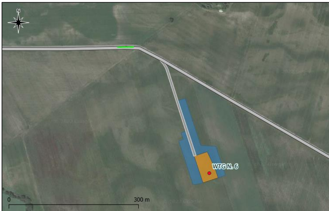
WTG 6 – Piazzola temporanea (in blu), permanente (in arancione) e viabilità di accesso (in grigio)
