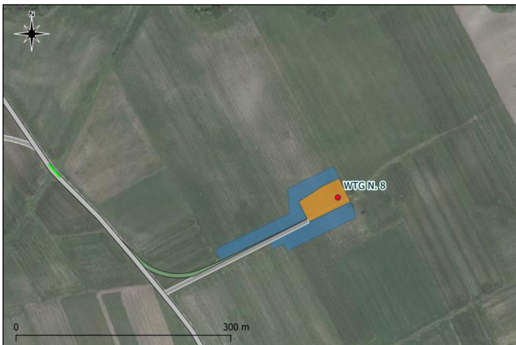
WTG 8 – Piazzola temporanea (in blu), permanente (in arancione) e viabilità di accesso (in grigio)
