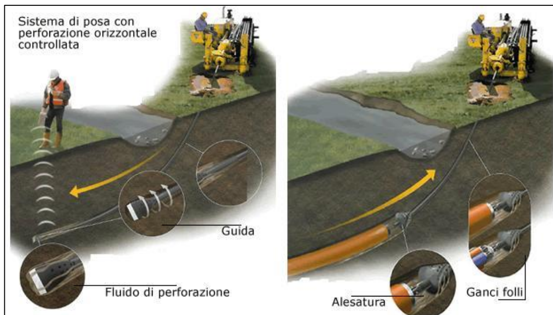
Posa in opera tubazione per alloggio cavi
