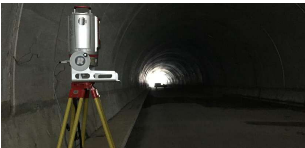
Figura 17 –Laser scanner RIEGL VZ-400i durante il rilievo della galleria Valpiana.
