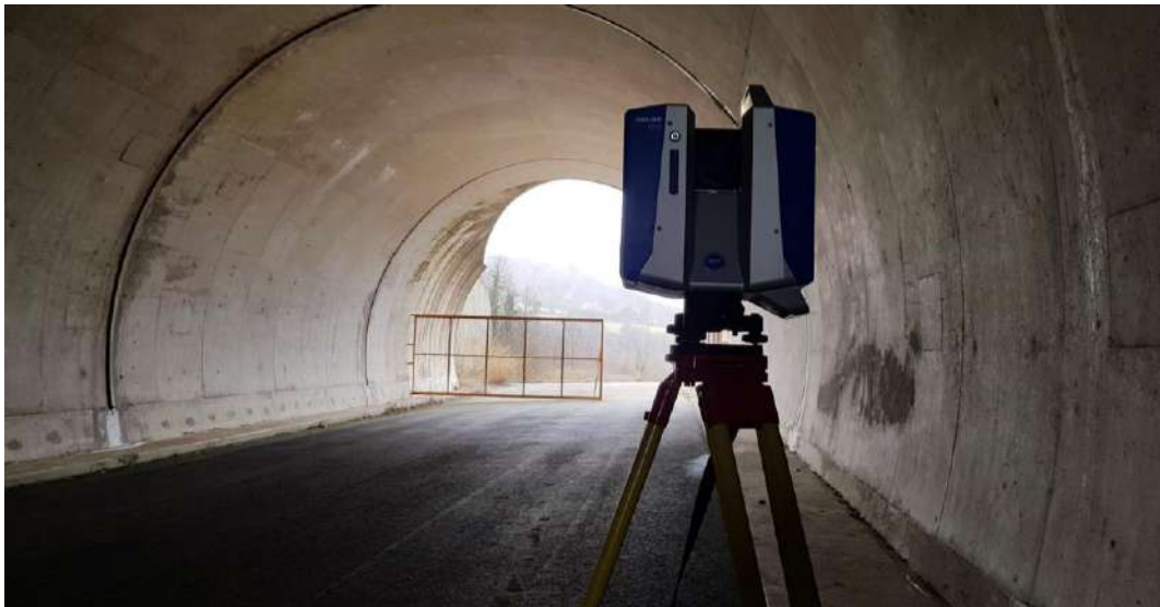
Figura 16 –Laser scanner Z+F – IMAGER – 5016 durante il rilievo della galleria Santa Veronica.
