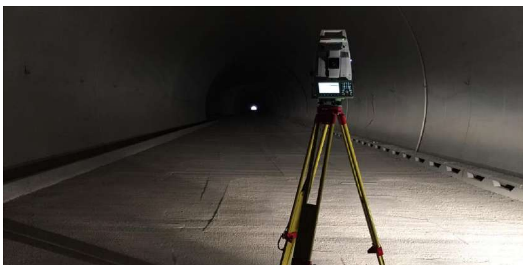
Figura 9 – Stazione totale Leica TS60 durante il rilievo della galleria Guinza.
