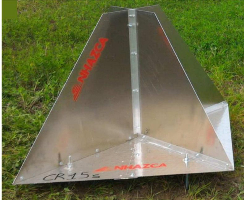
**Figura 31: esempio di un *corner reflector* progettato, realizzato e installato da NHAZCA S.r.l. in un'area vegetata priva di target radar idonei**
