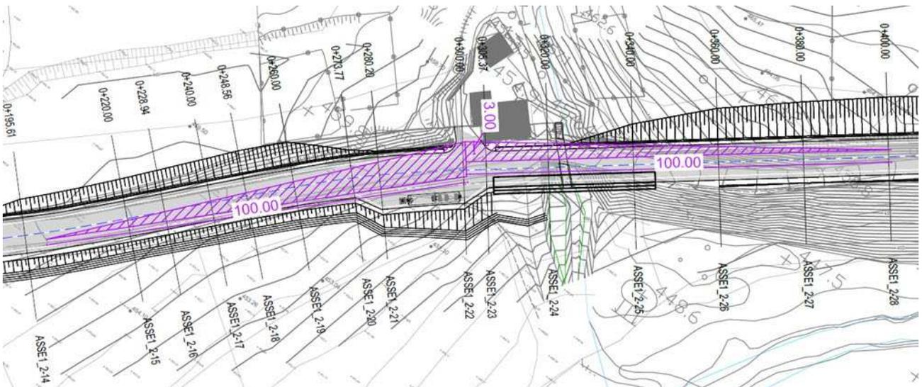
Figura 31 – Verifica visibilità accesso n.3 - progr. Km 0+300 - lato ovest
