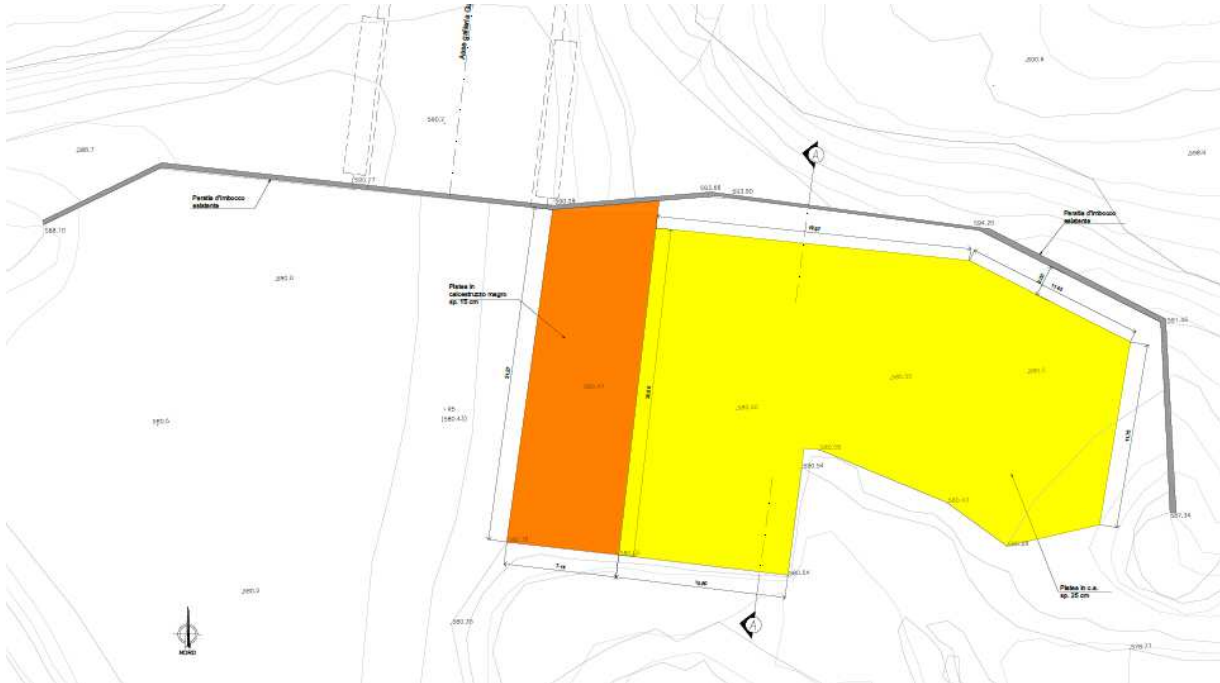
Figura 46 – Galleria Guinza- Imbocco lato Umbria – Demolizione della soletta in cls magro
