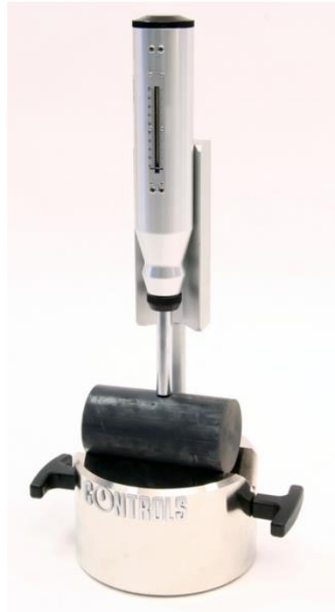
Figura 7 - Esempio di martello di Schmidt.
