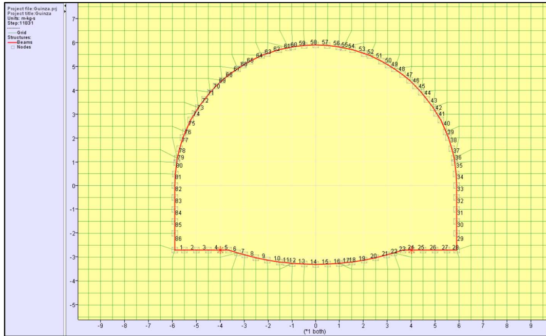
Figura 5 – Numerazione degli elementi beam e posizione delle cerniere (in asterisco) al passaggio tra murette gettate e arco rovescio non demolito
