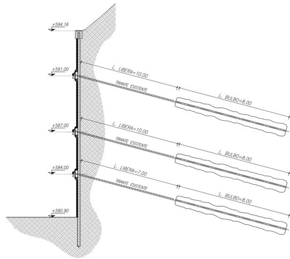
MURO DI SOSTEGNO A RIDOSSO DELLA PARATIA ESISTENTE - PIANTA
